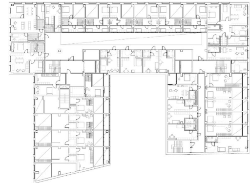
Kuva 4. Pohjapiirustus, 2. ja 3. kerros. Opinnäytetyön huoneistot noudattavat pilarijakoa ja huoneistojen muodostamisen perusajatuk-sena on ollut syvän rungon muodostaman pimeän tilan minimointi.
