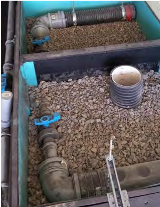
Kuva 5. Suodatinmassojen keskelle asennettiin salaojaputket kenttämittauksia varten. Poistoputken kanavat suojattiin metalliverkoilla (kuva Salla Pulliainen).
