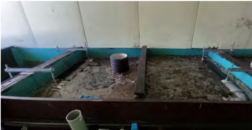
Kuva 8. Kuvassa reaktorin vasemmassa osassa on mittausputki, jonka avulla mahdollistettiin mittaussondin upottaminen keskelle suodatinmateriaalia (kuva Matti Hämäläinen).
