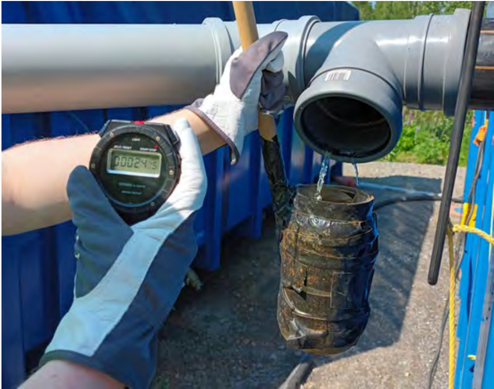
Kuva 5. Virtaamamittaus raudanpoistoyksikössä poistoputken näytteenottopisteestä astiamittauksella (kuva Salla Pulliainen).
