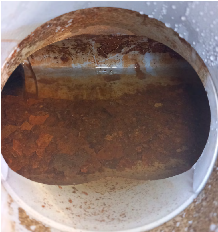
Kuva 15. Putkistoon kerääntyi järjestelmästä irronnutta rautaa. Kuva IBC-kontin ja bioreaktorin välisestä näytteenottopisteestä (kuva Salla Pulliainen).
