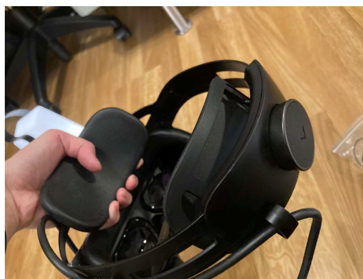
Kuva 17 Varjo Aero mukautuu helposti pään koosta riippumatta, näiden säätimien avulla (Hoque 2023k)
