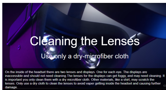
Kuva 6. VR-lasien linsejä saa puhdistaa ainoastaan mikrokuituliinalla (Hatton 2021a).
