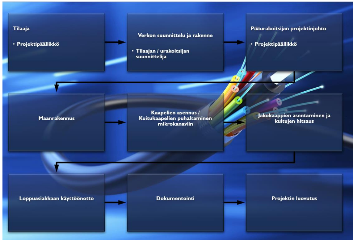
Kuva 6. Rakentamisen prosessikaavio (kuva A. Koskinen & A. Perälä)
