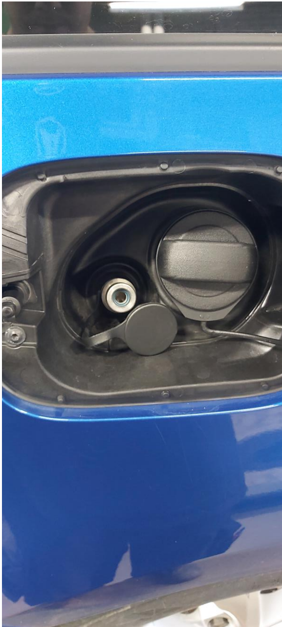
Kuva 2. Kaasun täyttöventtiili polttoainekannen alla.
