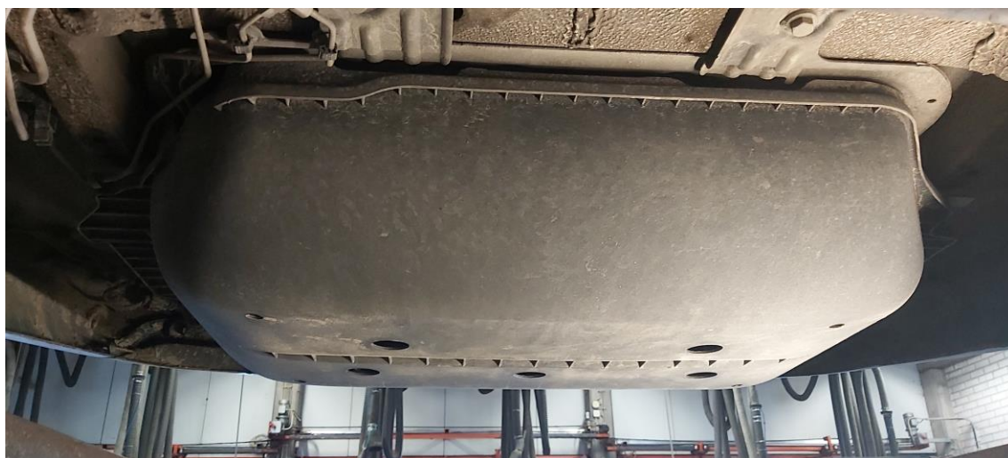
Kuva 3. Kaasusäiliöt auton alta kuvattuna muovikotelossa.
