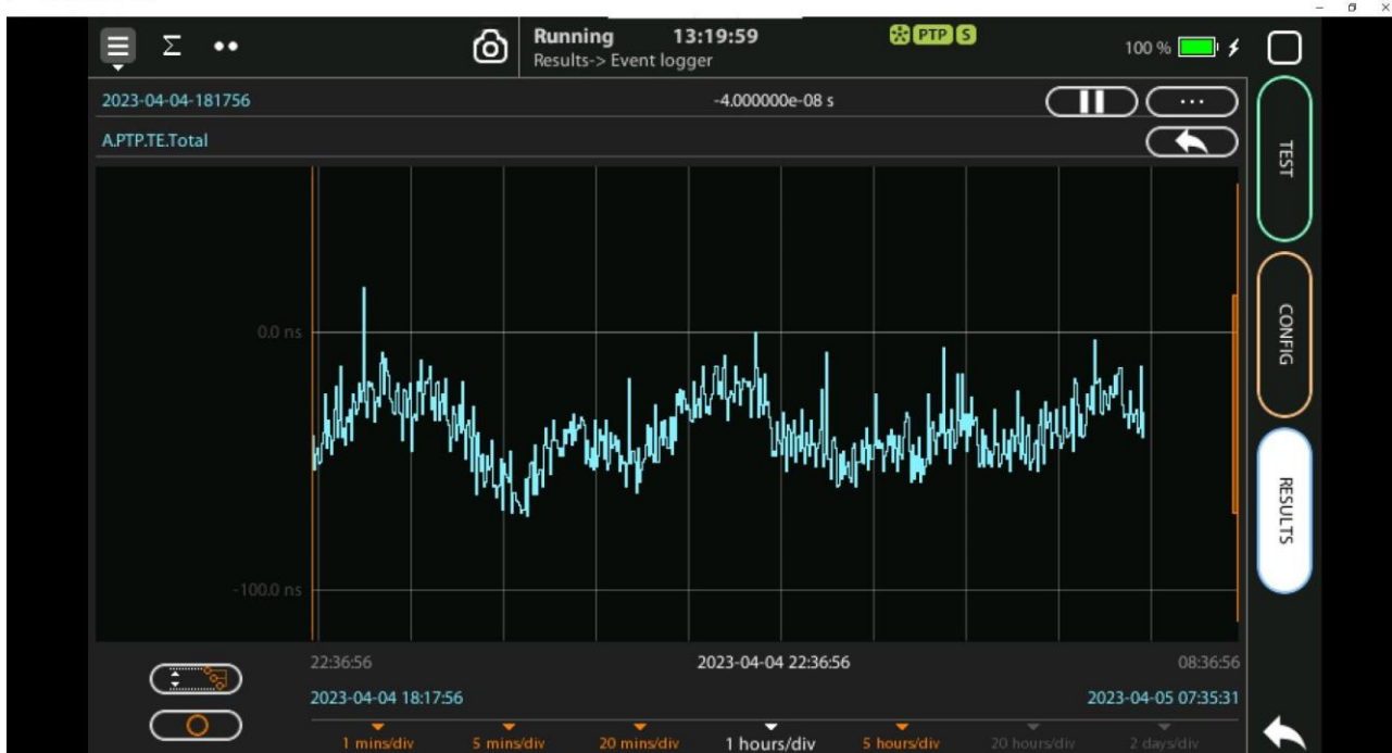
Kuvio 42. Siemens Ruggedcom RST2228 -prosessiväyläkytkimen aikavirhe 100 Mbit/s kuituportista
