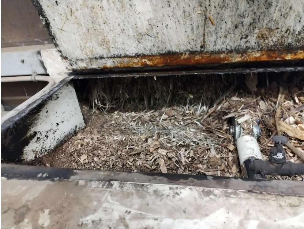
Kuva 9. Ruokomassa on tukkinut kokoojaruuvien syöttöaukon.
