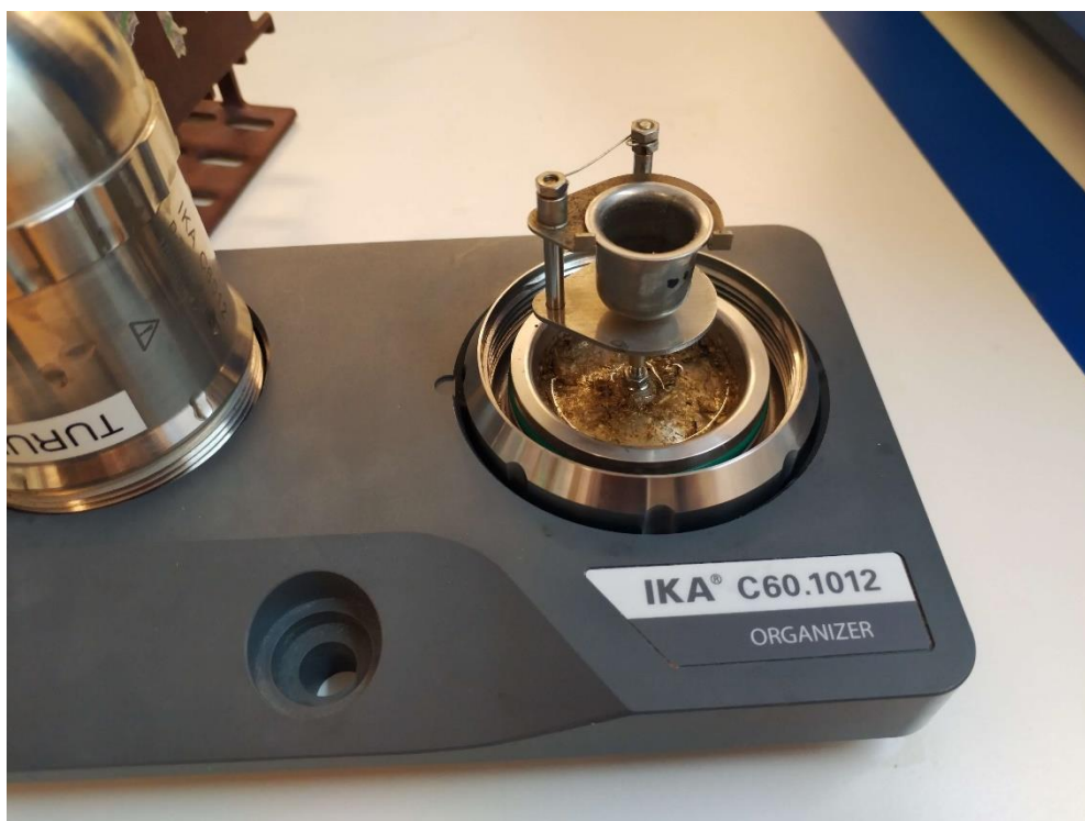
Kuva 6. Tabletin palaminen on keskeytynyt sen laskeutuessa astian pohjalla olevaan veteen.
