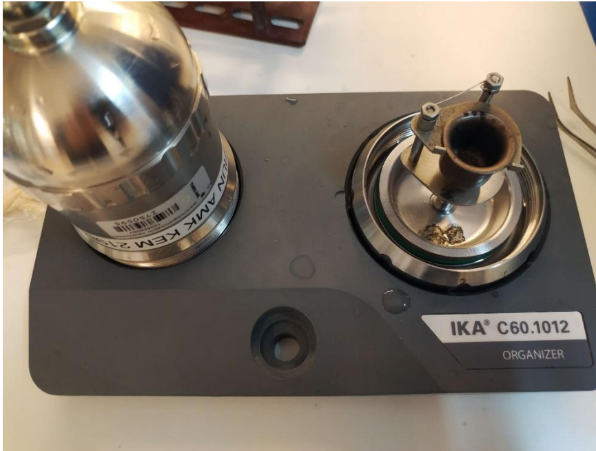
Kuva 7. Hiiltynyttä materiaalia hajotusastian pohjalla.
