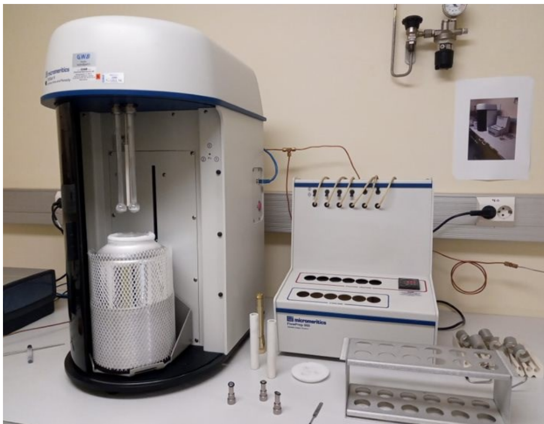
Kuva 7. BET-analyysilaitte vasemmalla ja näytteen esikäsittely-yksikkö oikealla.
