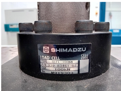
Kuva 13. Voima-anturin tyyppikilpi (Reijo Heikkinen 2023).
