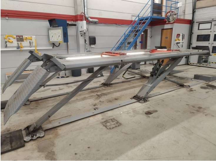
Kuva 3. Katsastusnosturi ravistimella ja kahdella keventimellä.
