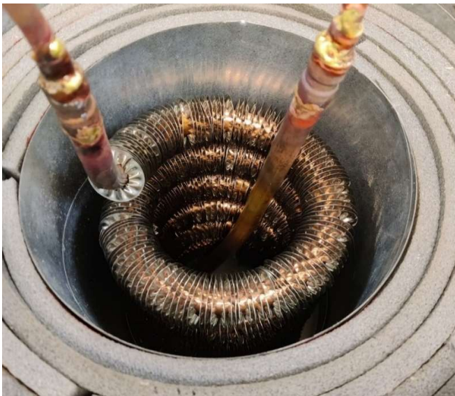
Kuva 15. Valmis kierukka lämpövaraston sisällä
