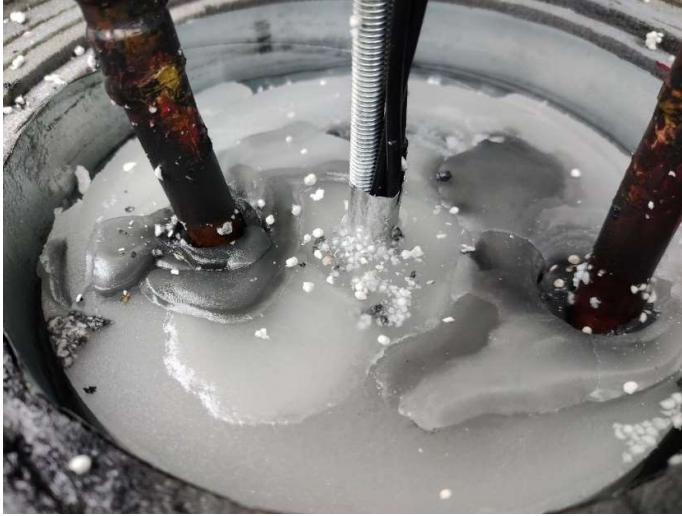
Kuva 21. Parafiinivahatäyttö koejakson jälkeen
