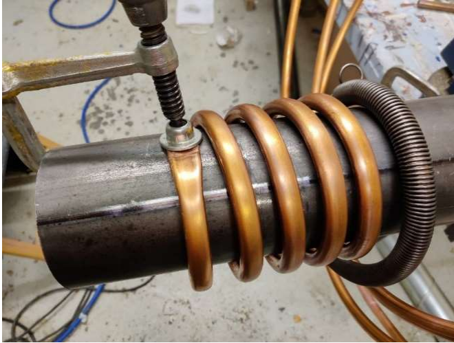
Kuva 14. Kierukan taivutus käynnissä
