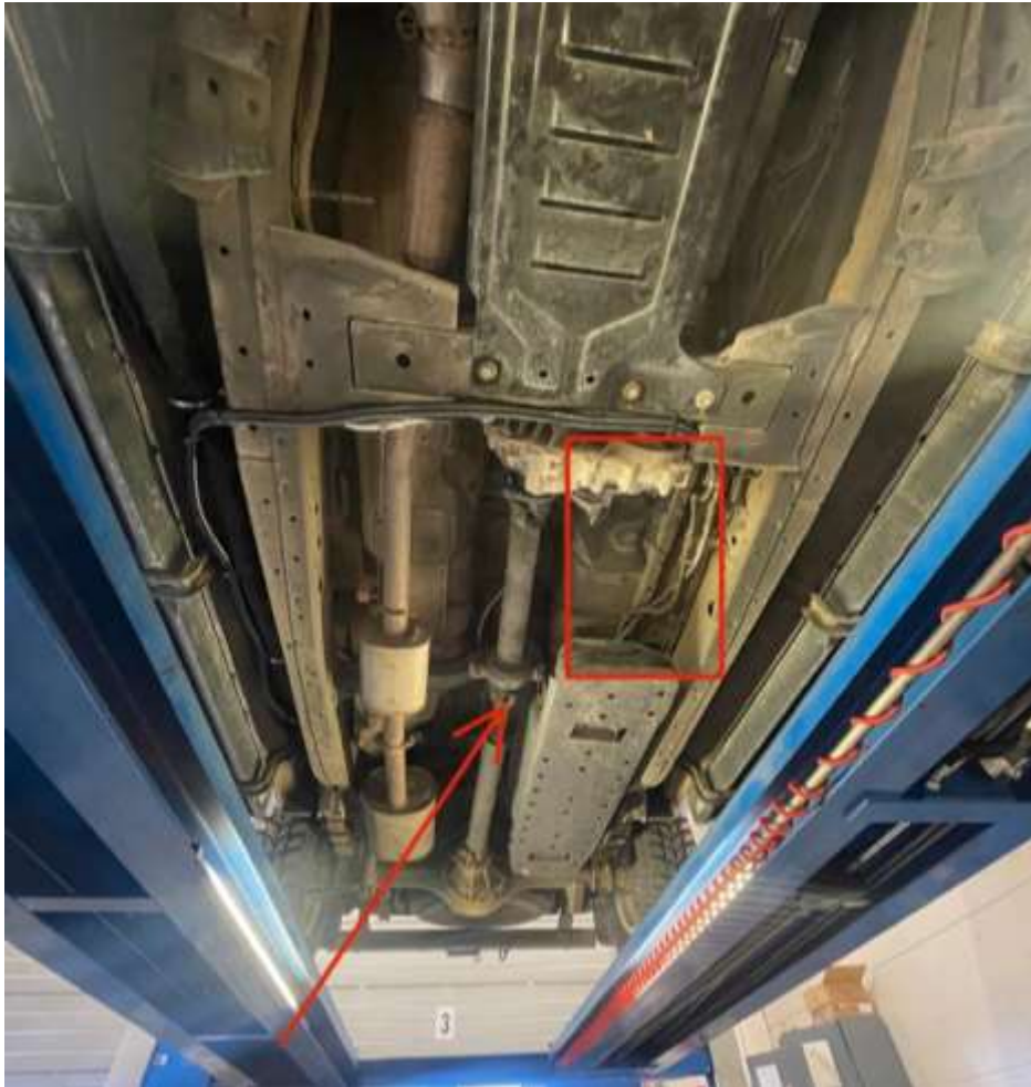
Kuva 3. Öljynjäähdyttimen toivottu paikka ajoneuvon pohjassa
