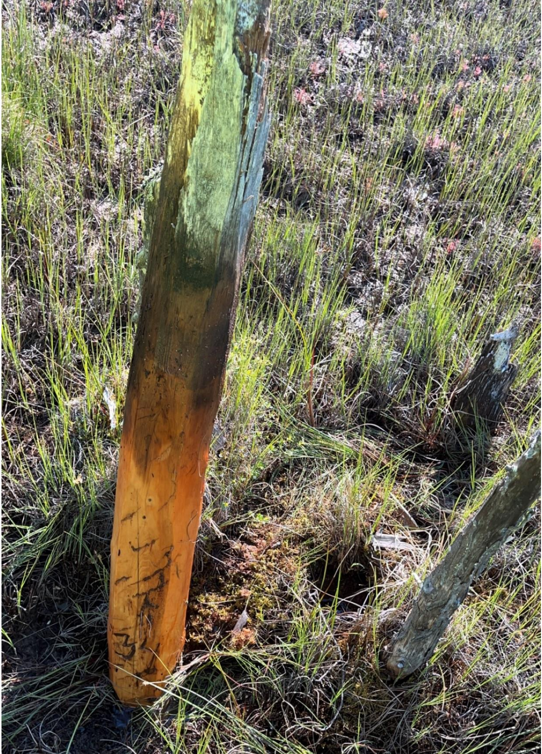
Kuva 3. Suon pinnan alla puu säilyy pitkiäkin aikoja. Puun alaosassa näkyy pyykin numero 34
