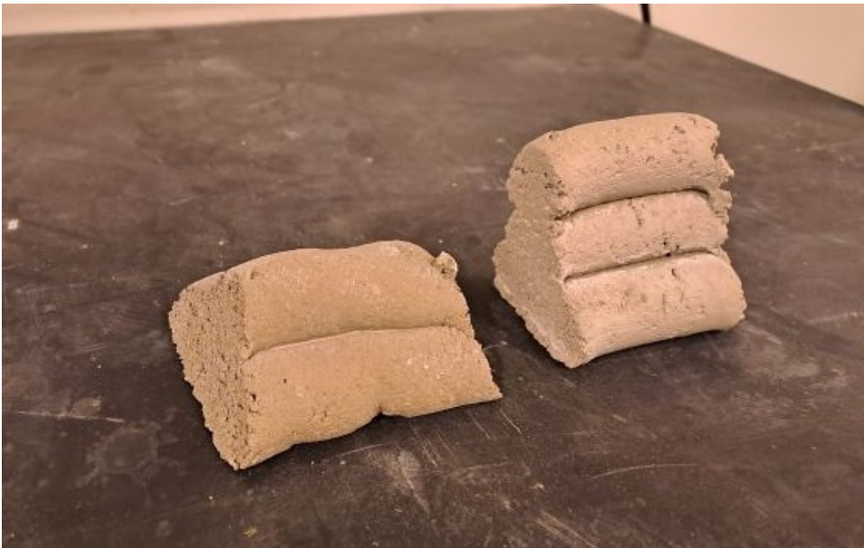
Kuvio 17. Koekappaleen 51 (vasemmalla) koepursotus verrattuna kappaleen 54 koepursotukseen (oikealla) (Kalle Jaakkola)
