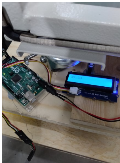
Kuva 13. Arduinon maadoitus runkoon sai näytön toimimaan, mutta lämpötila-arvo jäättyi paikoilleen.
