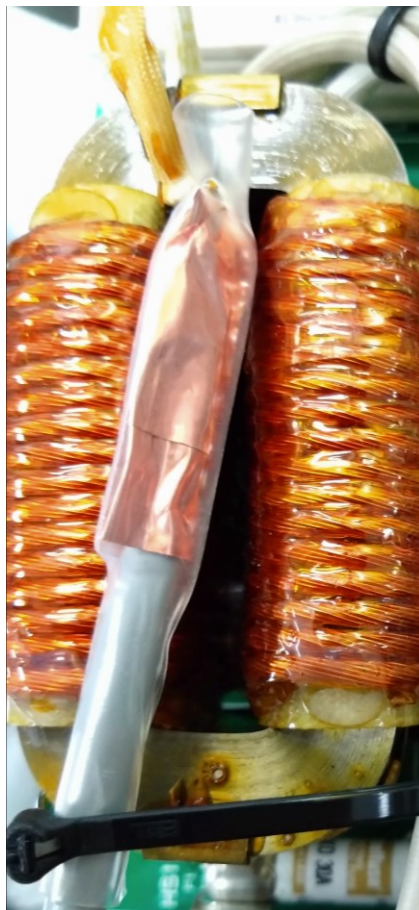
Kuva 21. Anturi häiriösuojattiin kupariteipillä.
