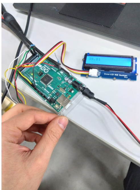
Kuva 8. Anturin kaapelinsuoja piti maadoittaa Arduinoon, jotta lämpötila oli luettavissa.
