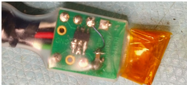
Kuva 5. Lämpötila-anturin TMP126 ensimmäinen testiin käytetty kortti.
