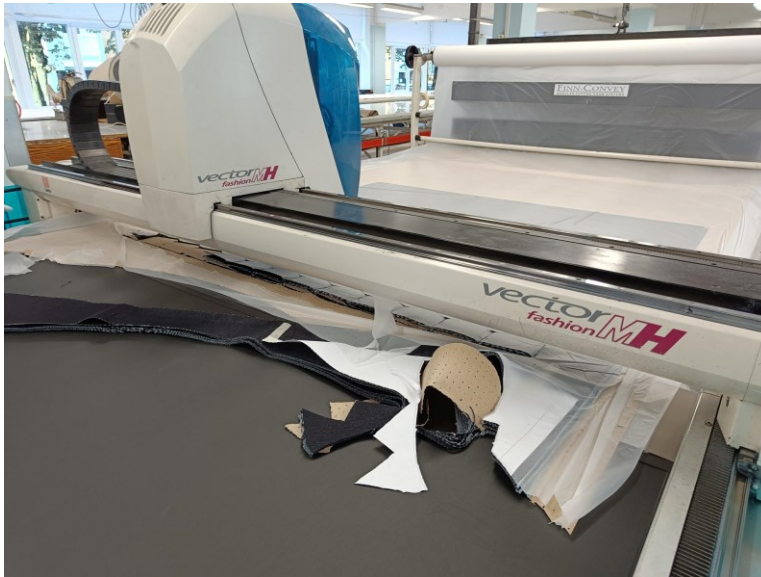
Kuva 4. Automaattileikkuri leikkaa farkkua. Kangaslaa'an alla on paperi ja päällä muovikalvo (kuva: Katri Ristola).
