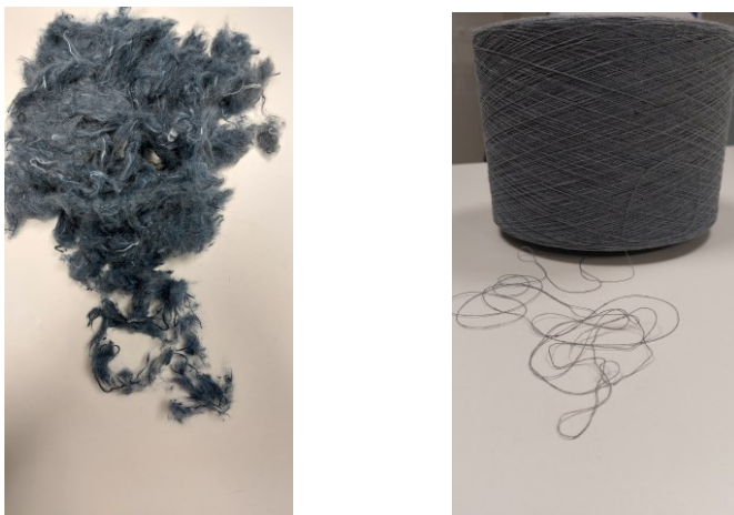
Kuvat 9 ja 10. Farkkukangasjätteestä valmistettua kierrätyskuitua Resteriltä ja lankaa Inovafiliiltä (kuvat: Anni Laukkanen, Rester Oy).
