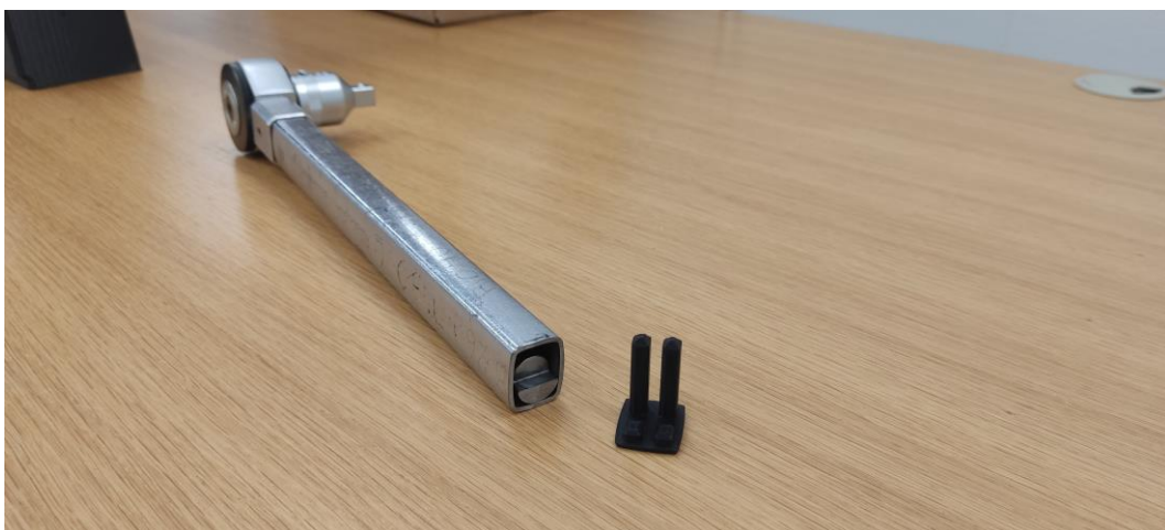
Kuva 59. Testipenkkiin muokattu momenttiväännin.
