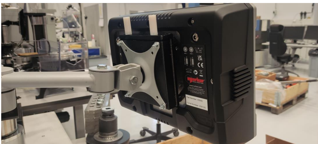
Kuva 58. Näytön PLA-materiaalista tulostettu pikakiinnike.
