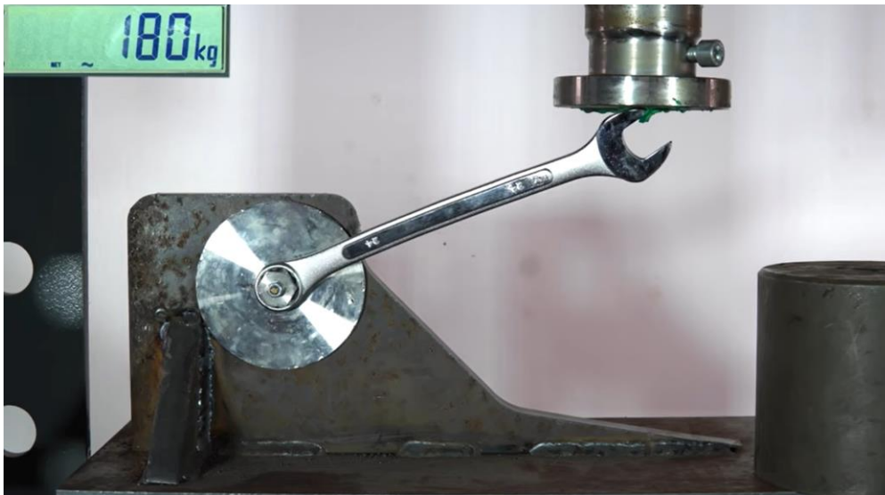
Kuva 28. Väntömomentin laskeminen voima-anturin avulla. /9/
