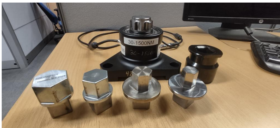
Kuva 31. Laipallinen vääntömomenttianturi ja työkaluadapterit.
