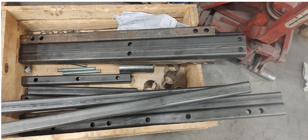
Kuva 52. Alustan rungon sahatut ja poratut neliöputket.
