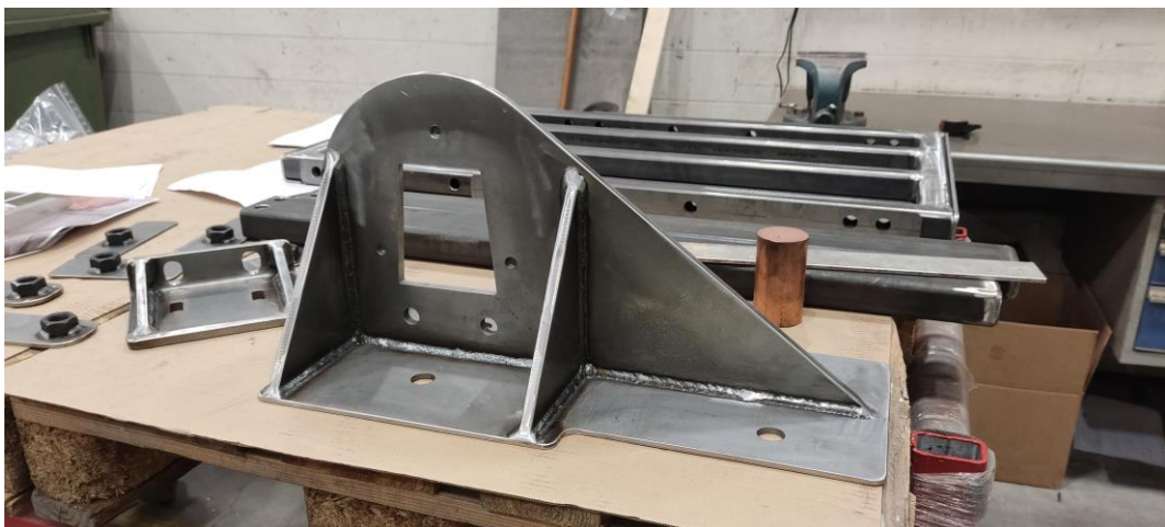
Kuva 54. Hitsattu jigi ja muita hitsattuja osia.
