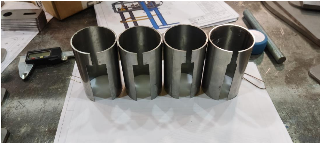
Kuva 53. Jyrsityt työkalujen pitimet.
