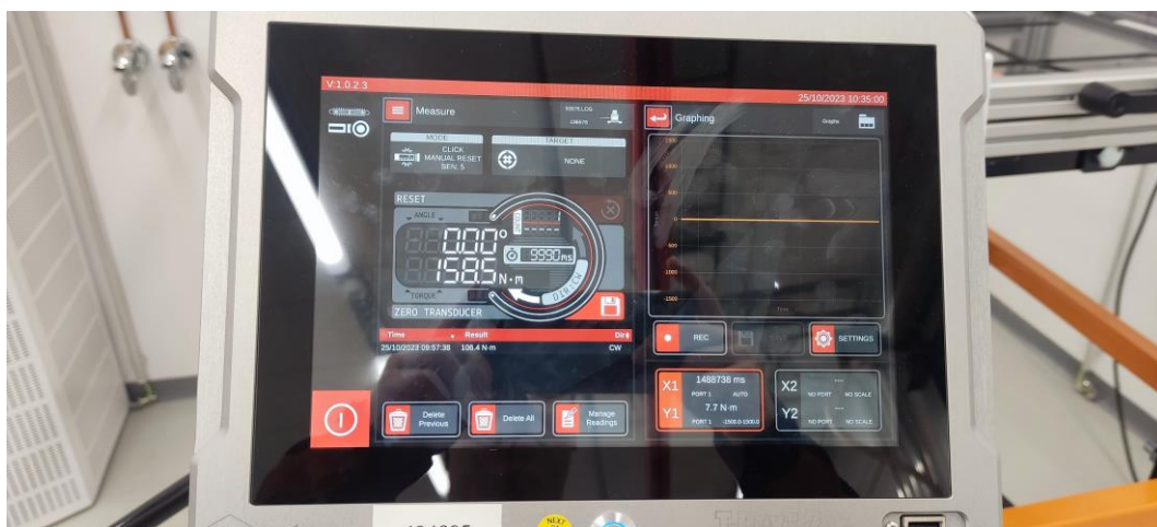
Kuva 81. 3D-tulostettu antureitten työkalun maksimivääntömomentti.
