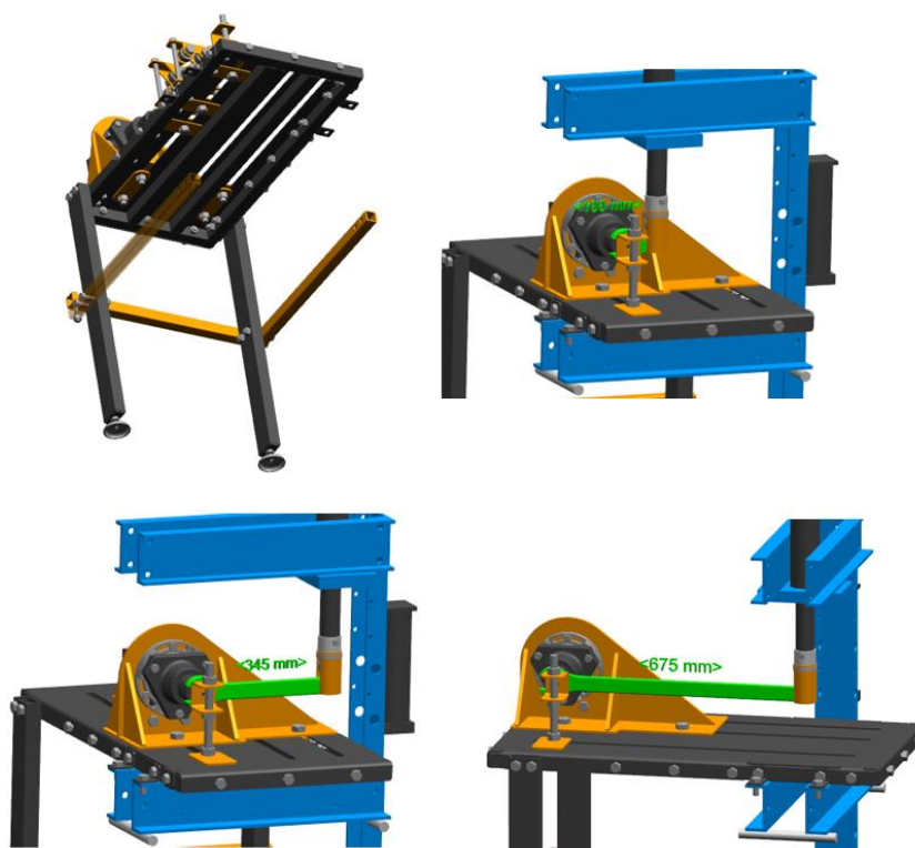
Kuva 41. Testipenkin säädettävyys kiintoavaimelle.
