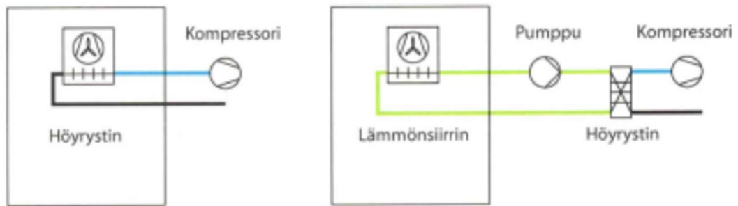
Kuva 3. Suora ja välillinen jäähditys (1, s. 75).
