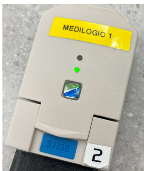
Kuva 2. MediLogic-pintapainemittauslaitteen lähetin. Kuvassa sinisellä pohjalla näkyvä 37/38 numerointi ilmaisee käytettävän pohjallisen koon.
