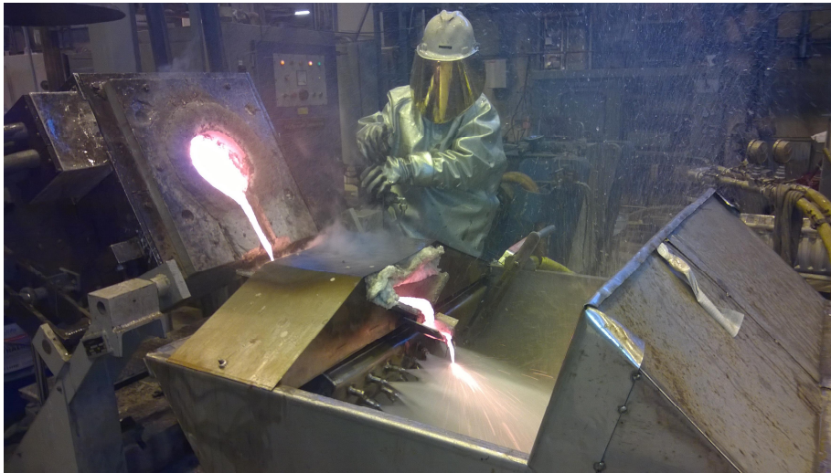
Kuva 12. Sulan kuparin kaato vesisuihkuun
