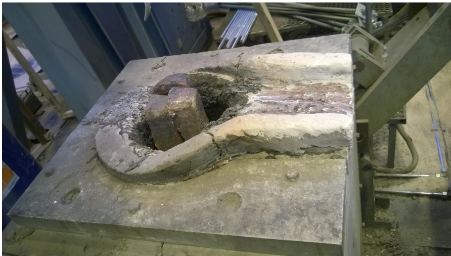
Kuva 11. Kuparin sulatus induktiouunissa. Ensimmäinen panostus.
