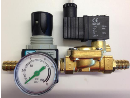
KUVA 24. Paineensäätöventtiili ja magneettiventtiili (PURSIAINEN 2014.)
