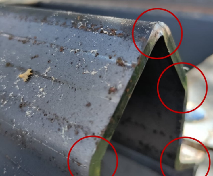
Kuva 56. Taivutuksen aiheuttamat muodonmuutokset
