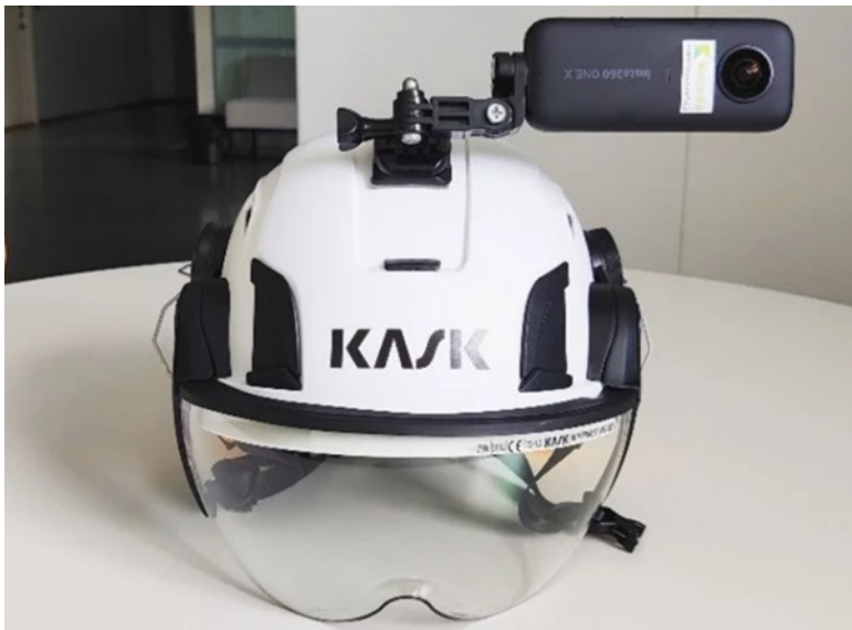
Kuva 14. Työmaakypärään kiinnitetyn 360-kameran avulla voidaan dokumentoida esimerkiksi laatuhavaintoja.
