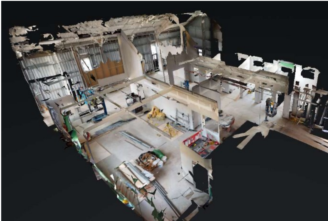
Kuva 11. Matterport-teknologialla voidaan kuvata fotorealistinen 3D-pistepilvimalli, jonka sisällä voidaan "kävellä".
