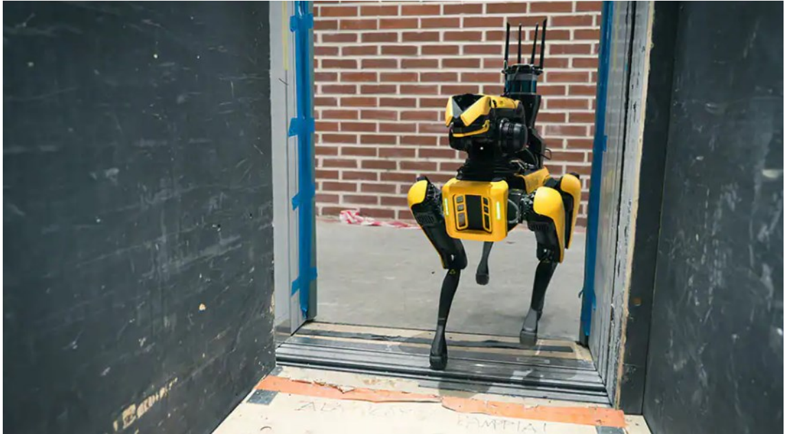
Kuva 13. Robottikoira Spot osaa käyttää jopa puheohjattua hissiä rakennustyömaalla (Kone).
