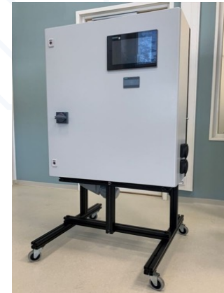
Kuva 7. Sähköauton latauskaappi liikuteltavassa telineessä. (Kuva: Jani Uotila)
