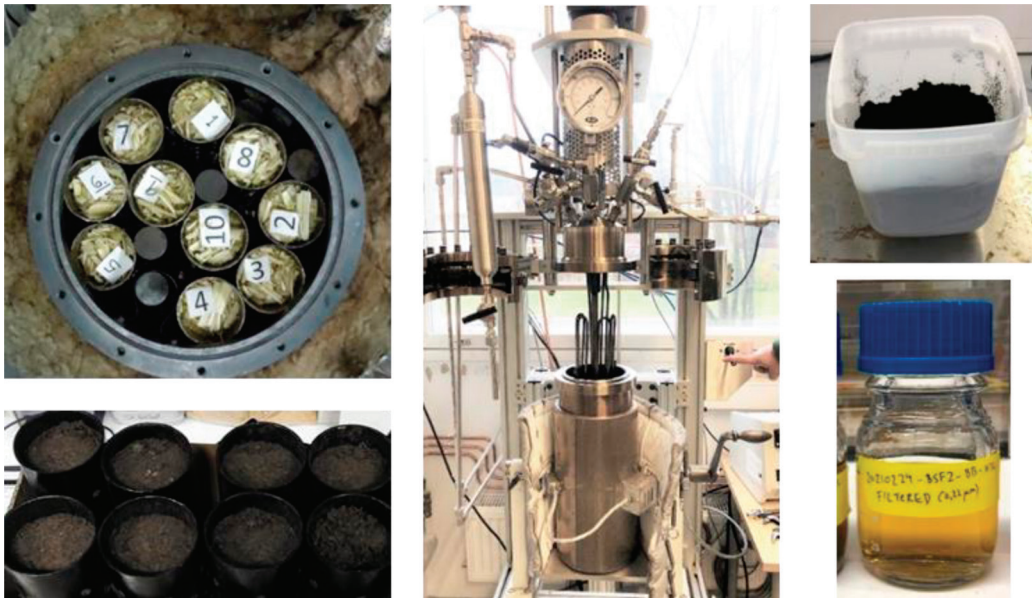
Kuva 1. Vas. ylhäällä: Biomassaa valmiina prosessoitavaksi UEF:n panostoisessa hidaspYROLYYSIREAKTORISSA. Vas. alhaalla: HidaspYROLYYSSILLA valmistettua biohiiltä. Kesk.: HTL-reaktori, UEF Joensuuun kampus. Oik.: HTL-prosessin lopputuotteita.
