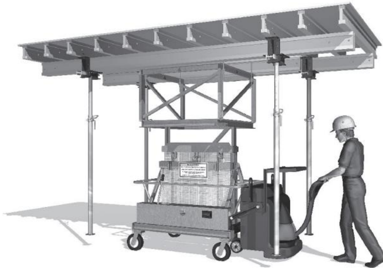
Kuva 8. Havainnekuva pöytämuotista (Doka muottimestarit 2005)
