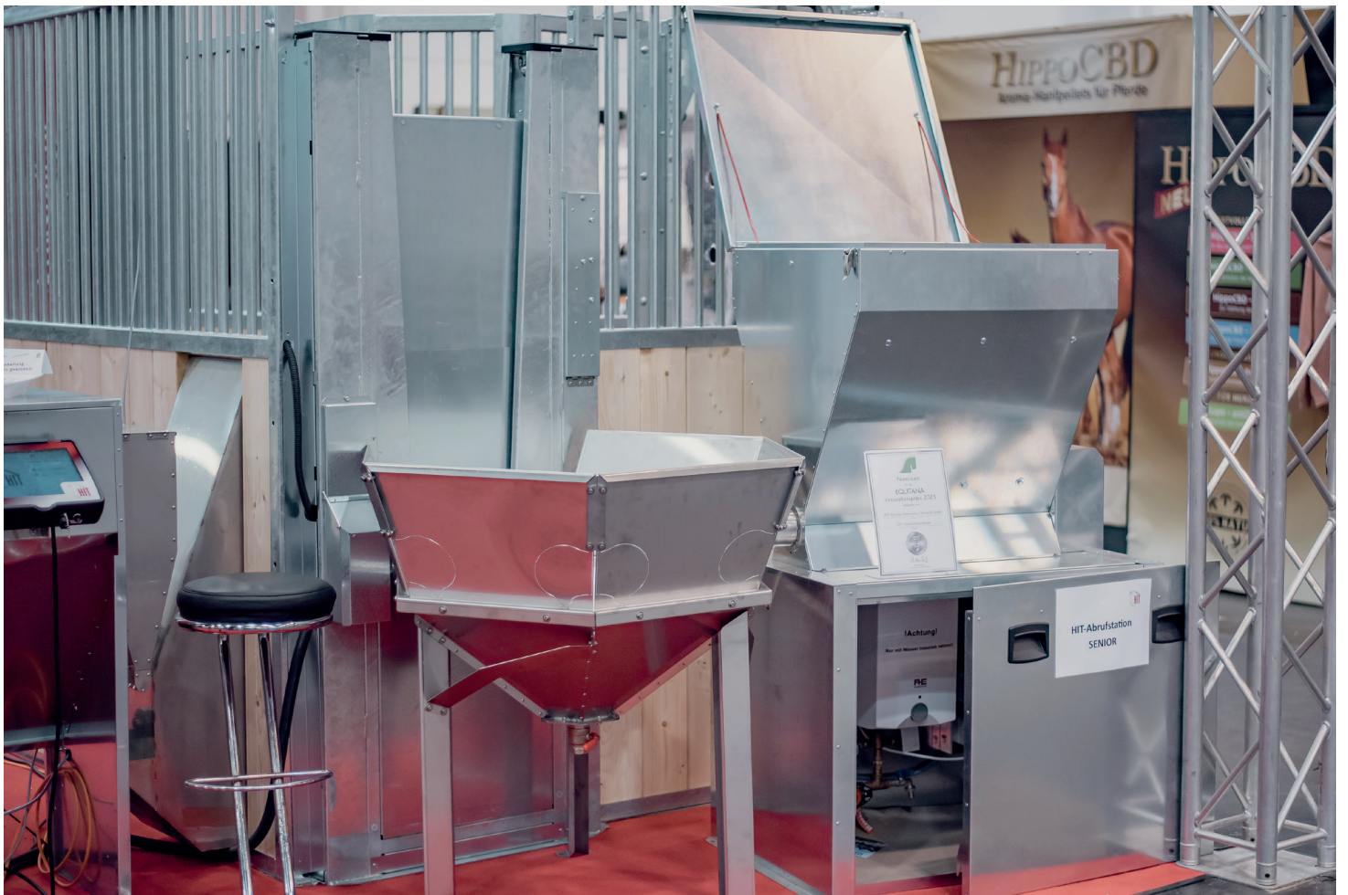
Uudessa pihatto-olosuhteisiin tarkoitettu ruokinta-automaattissa lämmin vesi pehmentää rehua.
