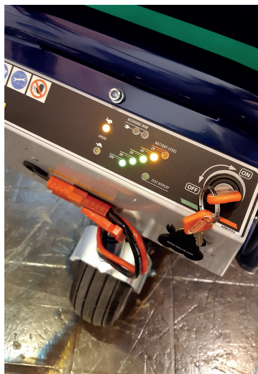
Vasemmalla akkukäyttöinen kottikärry, keskellä akkukäyttöisen kärryn ohjauspaneeli ja oikealla akkukäyttöinen paalikärry.
