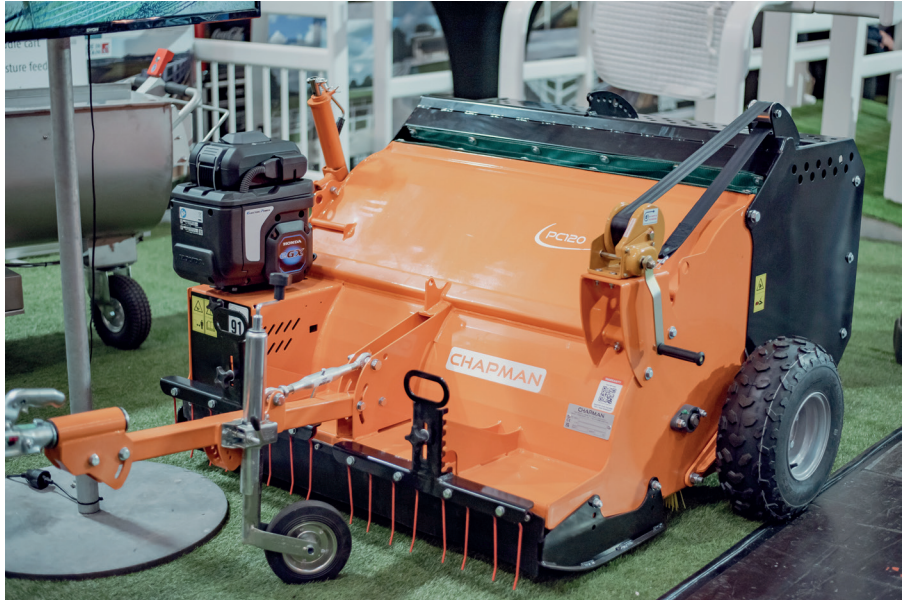
Mönkijän tai auton perässä vedettävä tarhan siivouskone, joka toimii joko bensamoottorilla tai sähköllä ladattavalla akulla.
