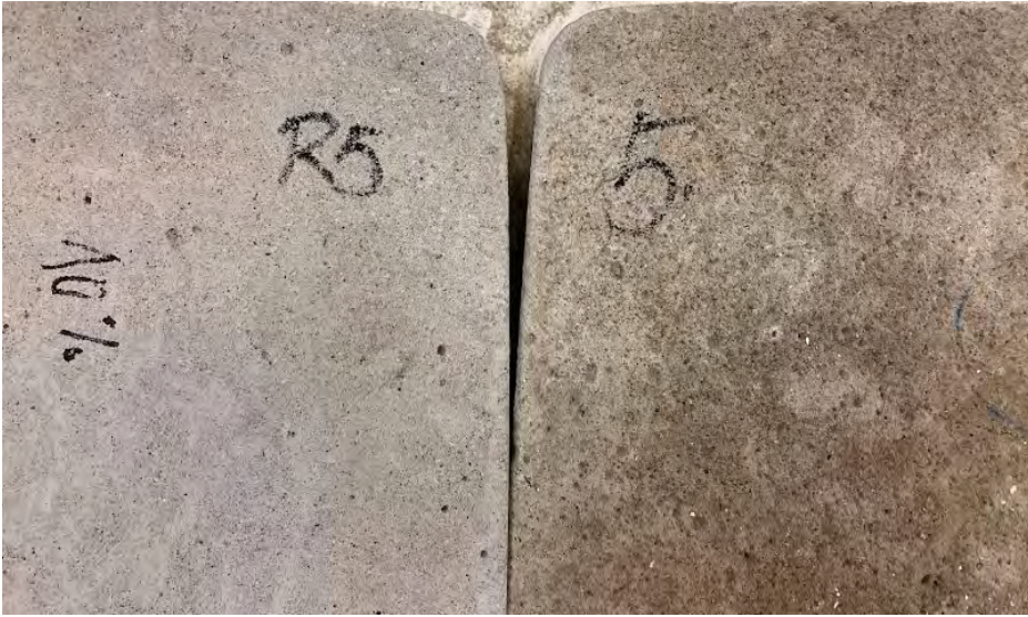
Kuva 6. Biohiilibetoninen pihalaatta (jauhettu 10 painoprosentin mäntyhake) pohjapuolelta kuvattuna. Referenssikappale on vasemmalla. (kuva: Anna Dunderfelt).
