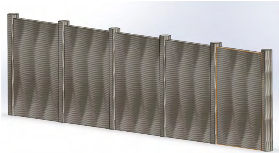
Kuva 2. Visualisointi 3D-tulostuksella toteutettavasta betonisesta meluaitarakenteesta (kuva: Mikko Hokkanen).
