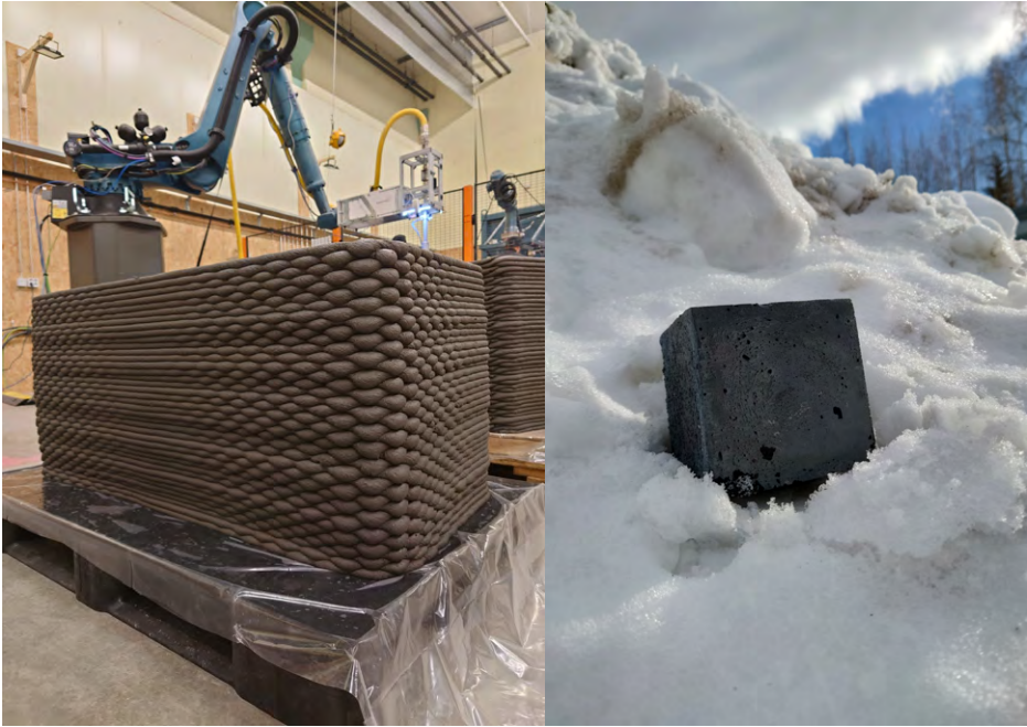
Kuva 3. Biohiiltä sisältävä 3D-tulostettavan seoksen kehittäminen (kuvat: Hyperion Robotics Oy).
