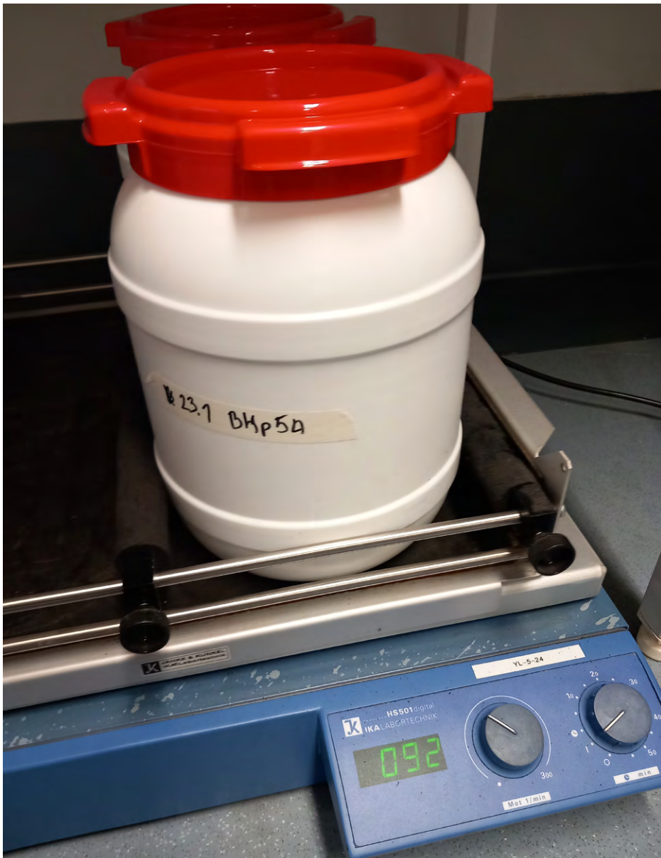
Kuva 1. Koekappale astian sisällä, ravistelunopeus säädetty sopivaan kierrosluukuun (kuva: Miia Sourander).
