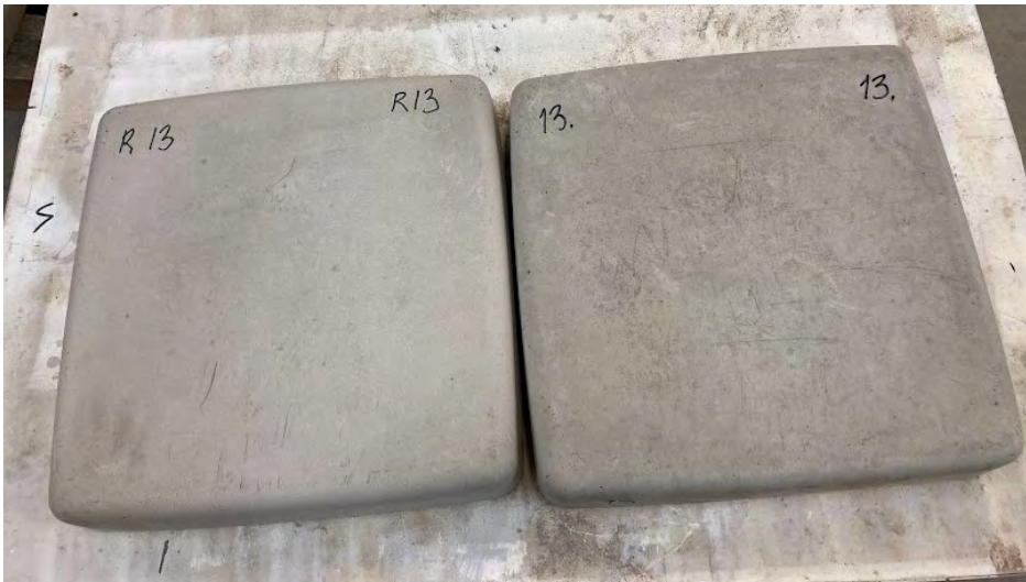
Kuva 5. Biohiilibetoniset pihalaatat (jauhettu mäntyhake, 2 painoprosenttia), ylempänä kuvasarja pohjapuolelta ja alempana pintapuolelta (kuva: Anna Dunderfelt).
