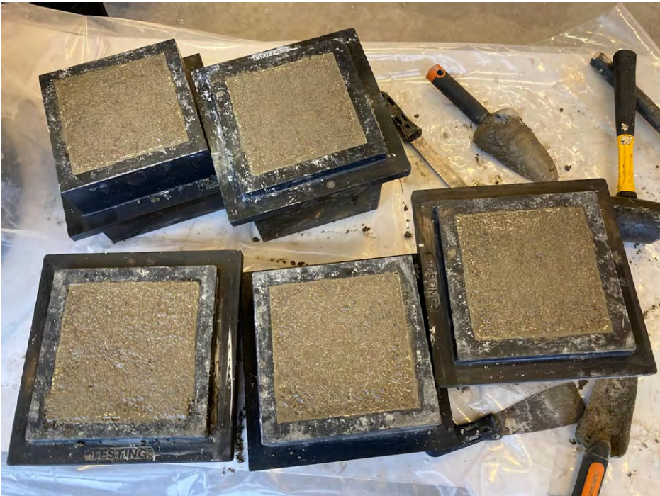
Kuva 1. Pakkaskestävyyden koekappaleita tiivistämisen jälkeen laboratorion lähettämässä muoteissa (kuva: Anna Dunderfelt).
