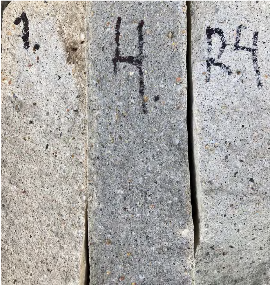
Kuva 8. Halkaistut pihalaatat vertailussa. Vasemmalla on normaali betoni ja keskellä sekä oikealla biohiilibetonit (jauhettu ~5 painoprosentin mäntyhake) (kuva: Anna Dunderfelt).
