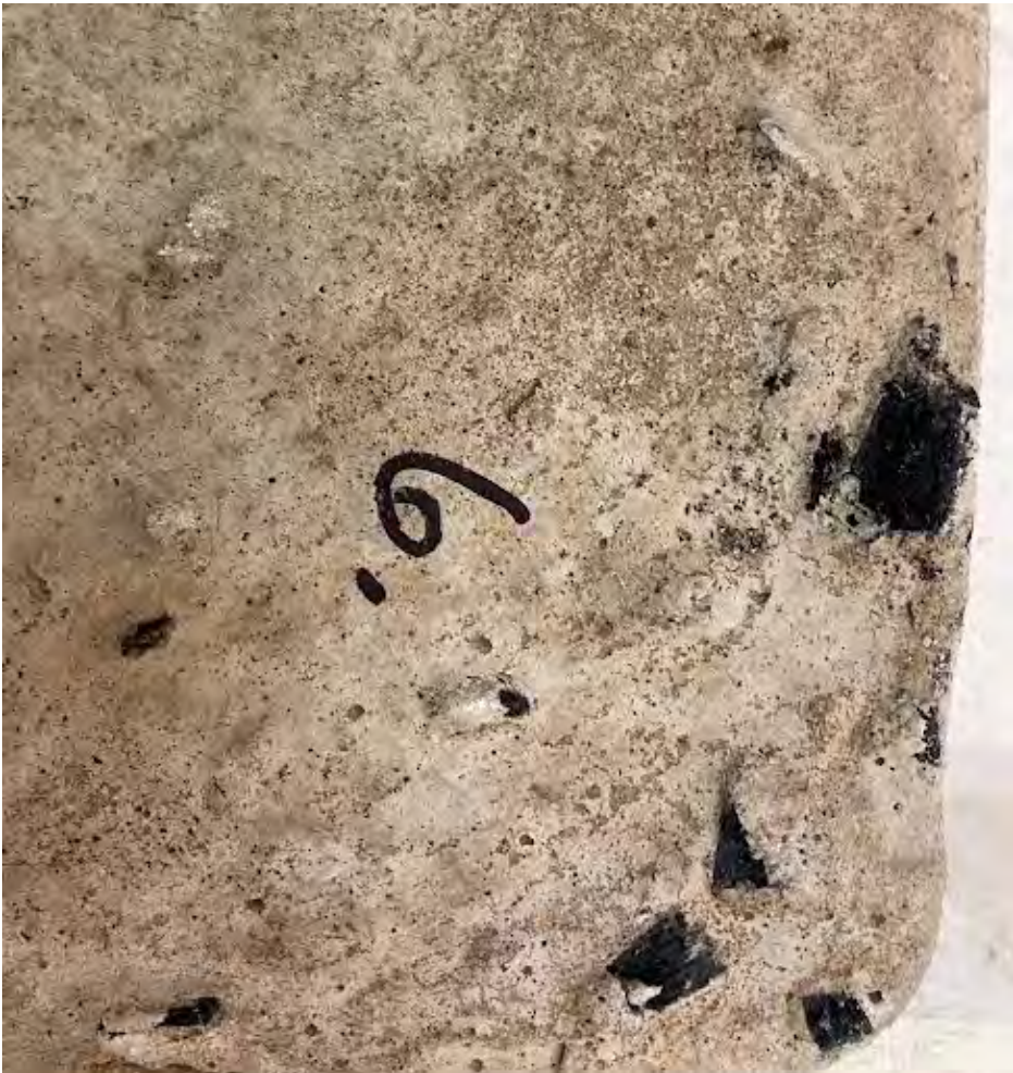
Kuva 7. Biohiilibetoninen pihalaatta (jauhamaton, karkea ~2 painoprosentin mäntyhake) pohjapuolelta (kuva: Anna Dunderfelt).
