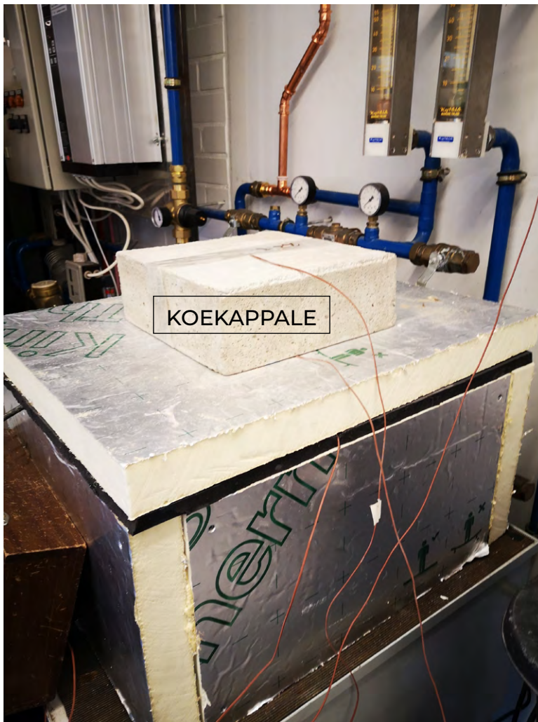
Kuva 5. Lämmönjohtavuusmittauksissa käytetty lämpölaatikko (kuva: Mikko Hokkanen)
