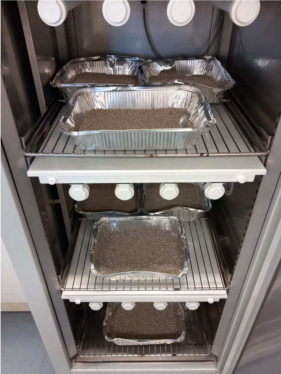
Kuva 9. Näytteet olosuhdekaapissa kolmessa tasossa, hyllyllä yksi jokaisesta koesarjasta (kuva: Miia Sourander).
