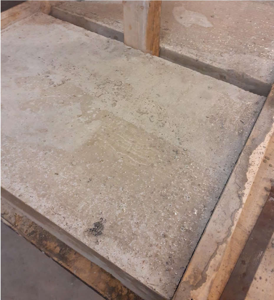
Kuva 3. Ääneneristystestauksen koekappaleet valmiina muoteista irrotukseen (kuva: Miia Sourander).
