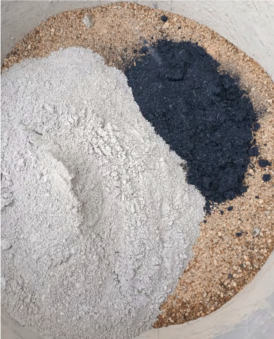
Kuva 2. Hankkeen kokeissa biohiilellä korvattiin sementtiä eri seossuhteilla (kuva: Anna Dunderfelt).
