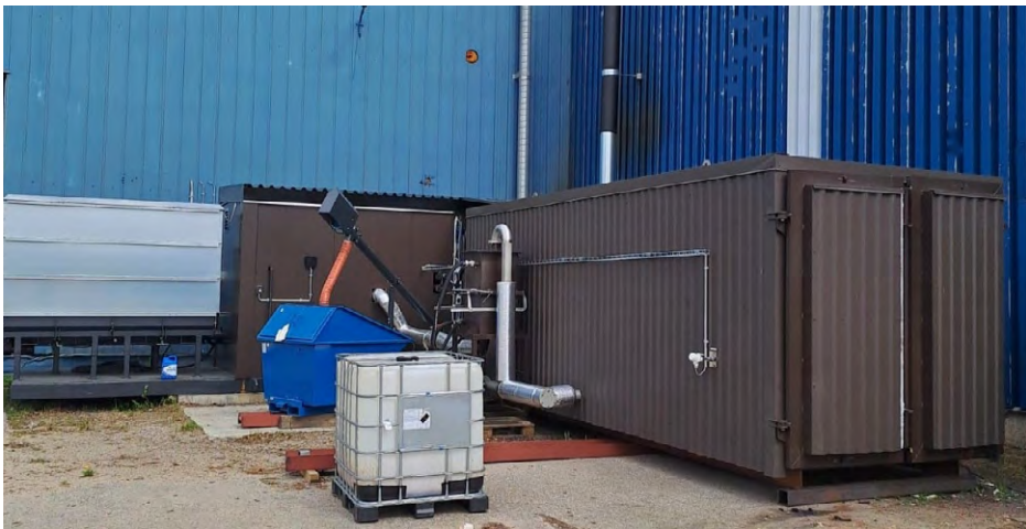
Kuva 1. Biohiilen valmistuslaitteisto, joka kerää talteen tisleet ja kaasut (kuva SoilCare Oy).
