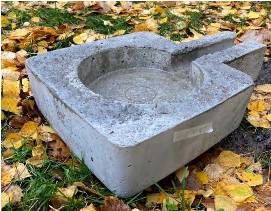
Kuva 1. Biohiilibetoninen kevyt hulevesirakenne, jossa on korvattu sementtiä kahden painoprosentin osuudella (kuva: Anna Dunderfelt).
