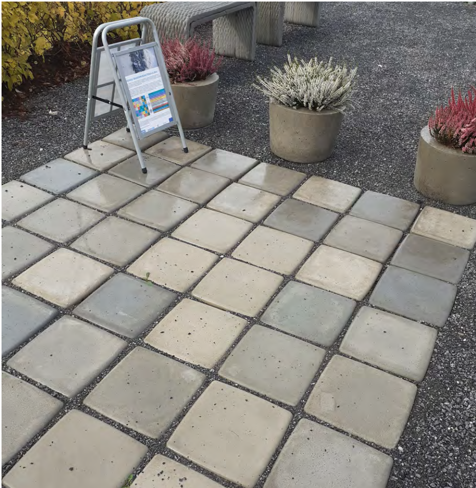
Kuva 4. Sateisellä säällä laattojen sävyerot tulivat selvästi esille (kuva: Miia Sourander).
