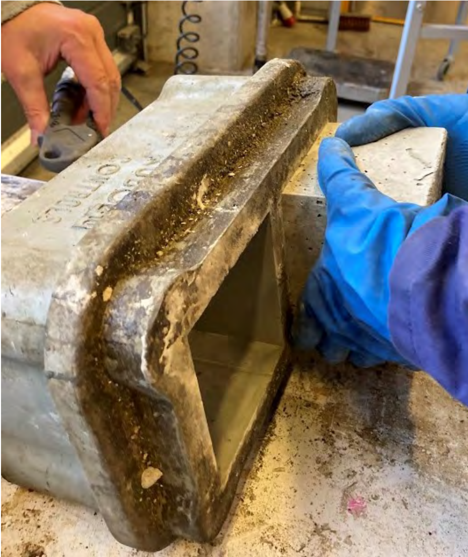
Kuva 1. Koekappaleiden irrotus muoteista ilmanpaineen avulla (kuva: Anna Dunderfelt).
