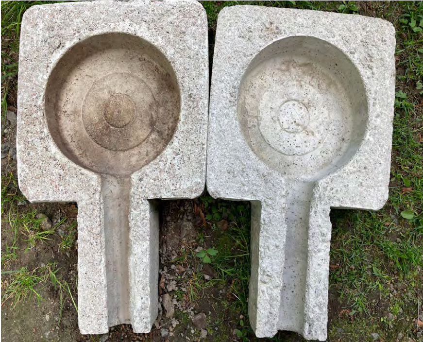
Kuva 9. Kevyet hulevesirakenteet, vasemmalla on biohiilibetoninen ja oikealla normaali betoni (kuva: Anna Dunderfelt).
