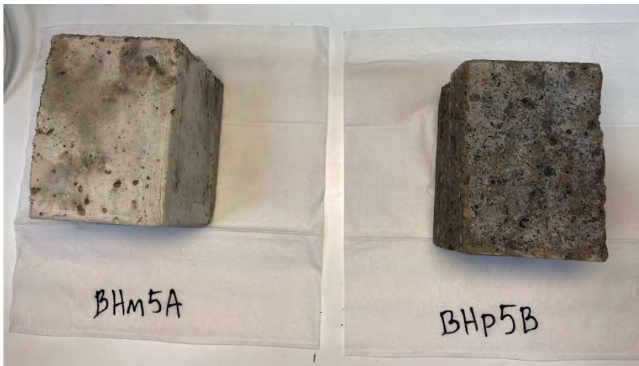
Kuva 2. Vasemmalla ~5 painoprosentin mäntyhakebiohiili A-näyte ja vasemmalla ~5 painoprosentin purkupuubiohiili B-näyte (kuva: Anna Dunderfelt).
