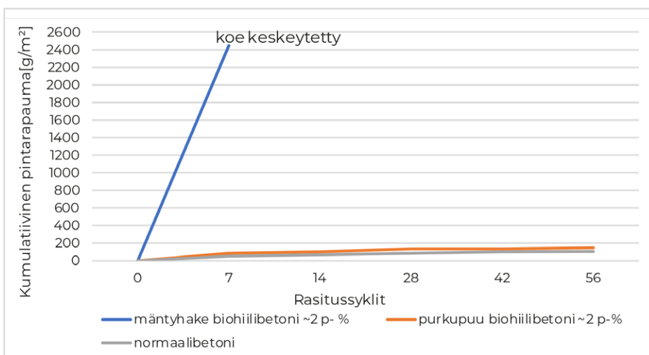
Kuva 2. Kumulatiivinen pintarapautuma (g/m 2 ) laattakokeessa CEN/TR 15177 deionisoitu vesi, testipinta-ala (m 2 ) (tiedot: Eurofins Expert Services Oy)
