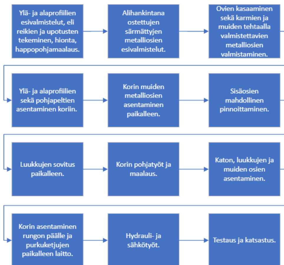
Kuva 3. Koritehtaan kokoonpanon yksinkertaistettu layout.
