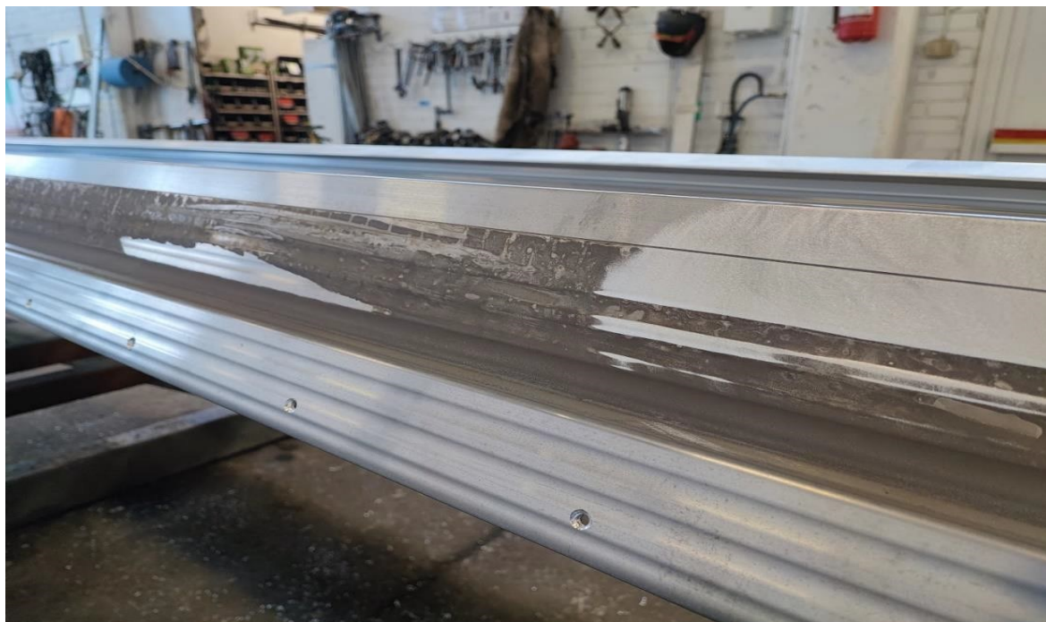
Kuva 8. Alaprofiilin muoto ja hapettunut pinta. (Tomi Jetsonen, 2023, CC BY).
