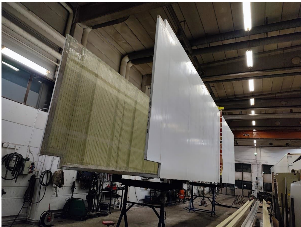
Kuva 5. Tyhjä komposiittikori nostettuna pukkien päälle pohjapeltien ja alaprofiilien asennusta varten. (Tomi Jetsonen, 2023, CC BY).
