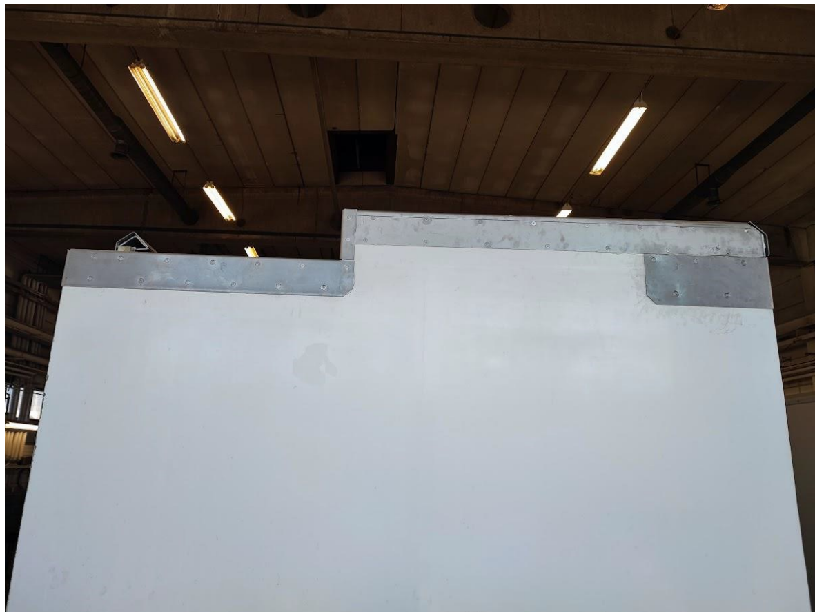
Kuva 11. Etuseinän metalliosia asennettuna komposiittikoriin. Seuraava työvaihe puuttuvien osien asentaminen ja osien hitsaaminen yhteen saksinosturin avulla. (Tomi Jetsonen, 2023, CC BY).
