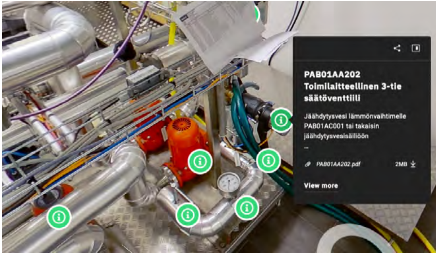
Kuva 6. Höyryprosessin osa- ja komponenttitietojen esitystapa.
