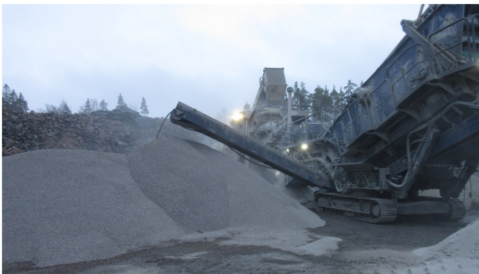
Kuva 1. Murskauslaitos ja seula sekä valmista 3–6 mm:n hiekoitussepeliä.
