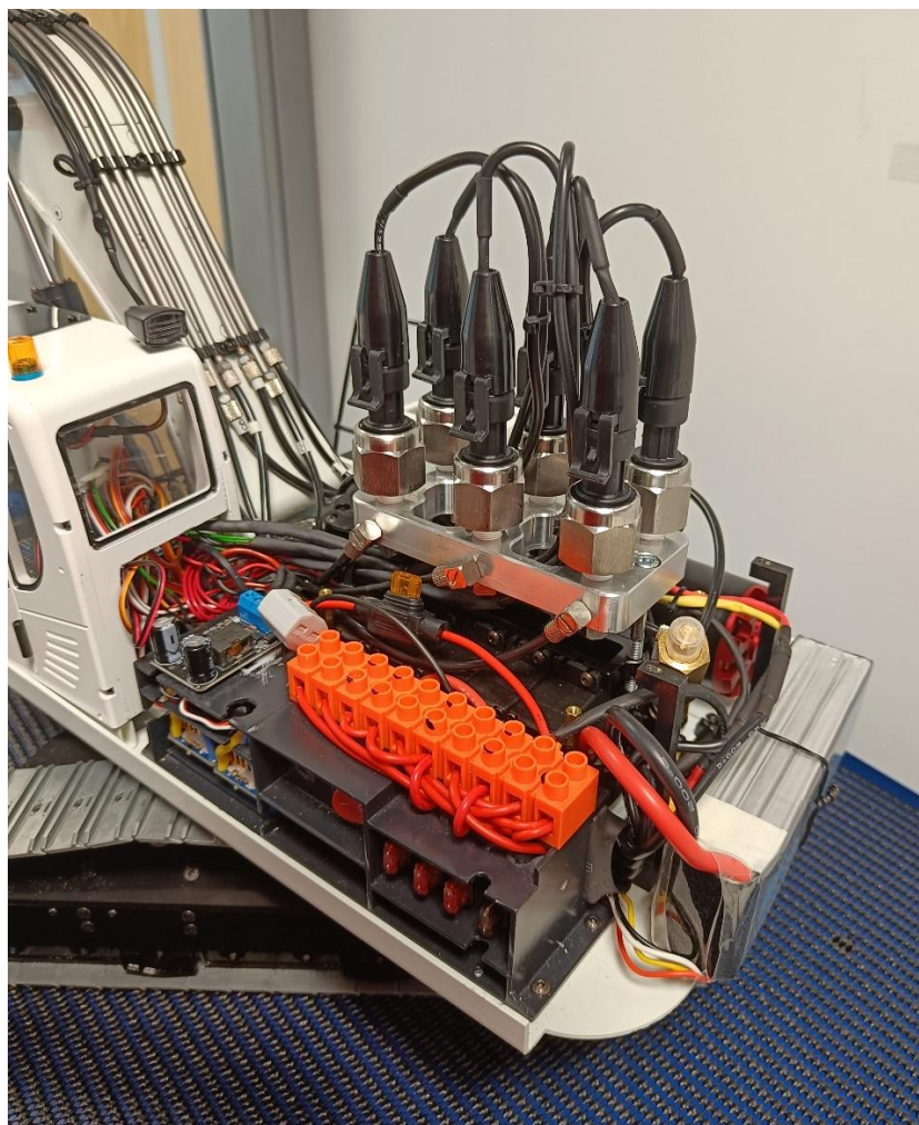
Kuva 16. Anturipöytä asennettuna (Miettinen 2022)
