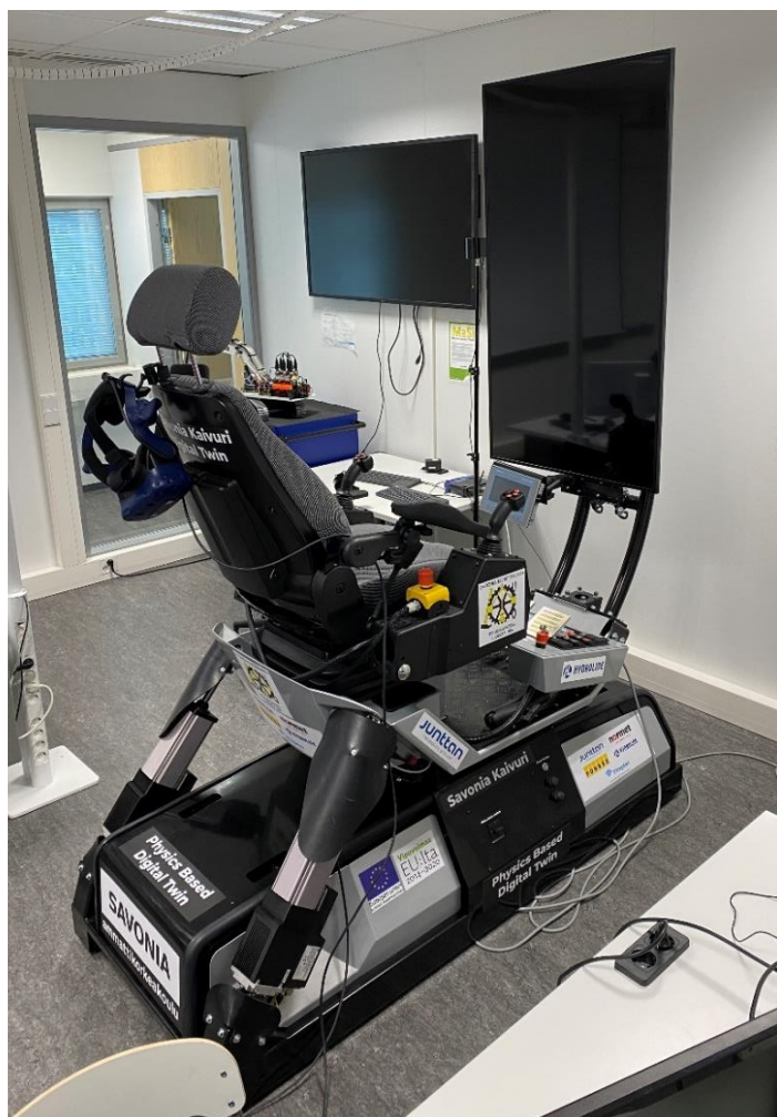
Kuva 10. Motion Platform (2DOF) ohjauslaite (Miettinen 2022)
