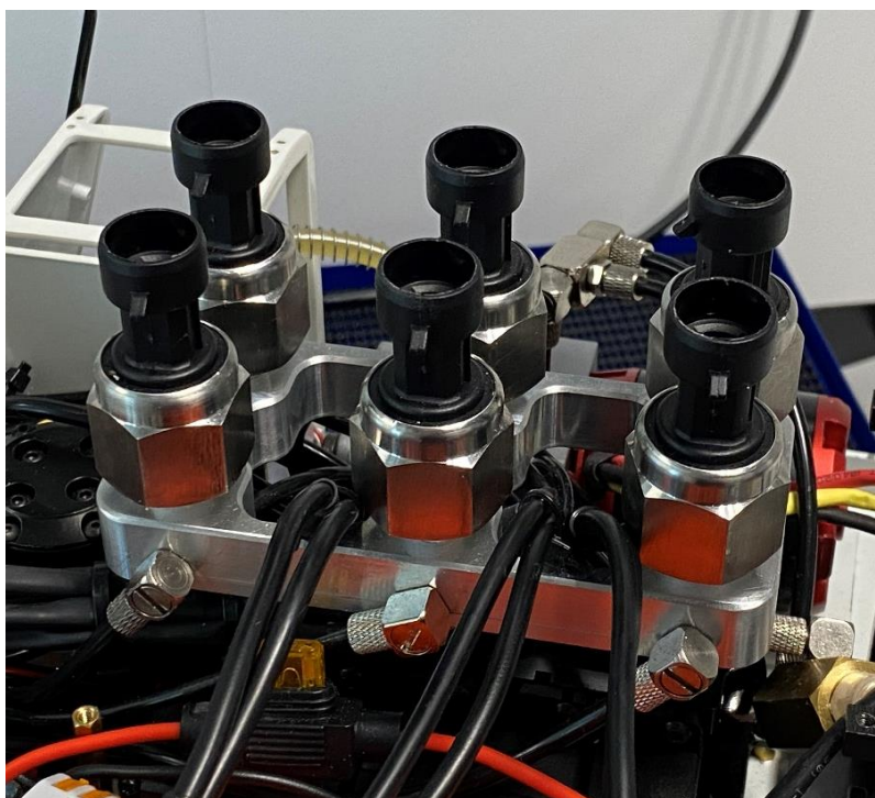
Kuva 11. Kaivuriin kytketyt paineanturit (Miettinen 2022)
