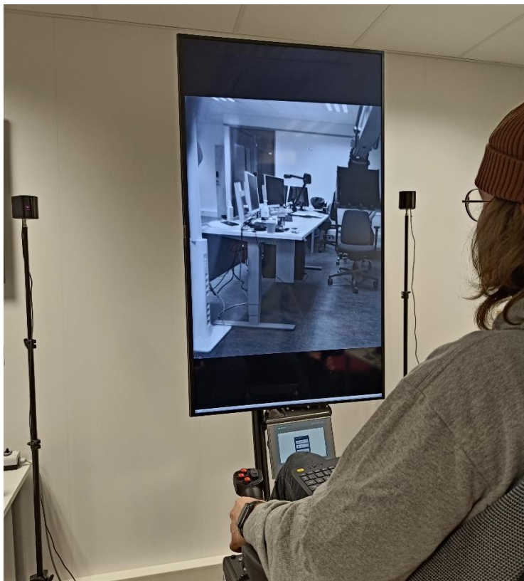
Kuva 34. Kaivurin videoyhteyden testaamista (Hänninen 2022)
