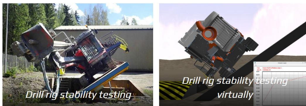
Kuva 2. Sandvikin hyödyntämä porauslaitteen testausympäristö Mevea-simulointiympäristössä (Mevaa, 2018)
