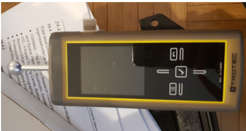
KUVA 1. Pintakosteusmittari, Trotec T660
