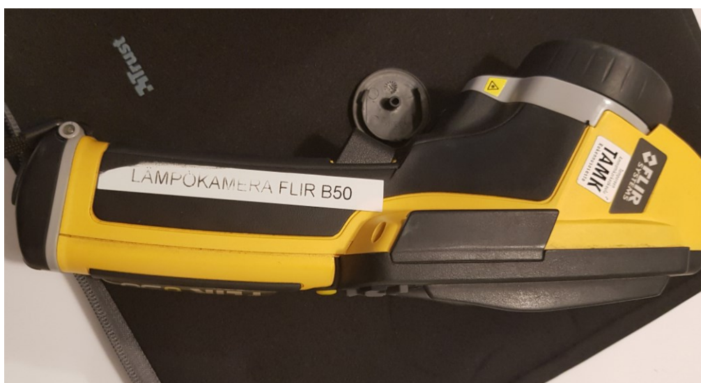
KUVA 2. Lämpökamera Flir B50
