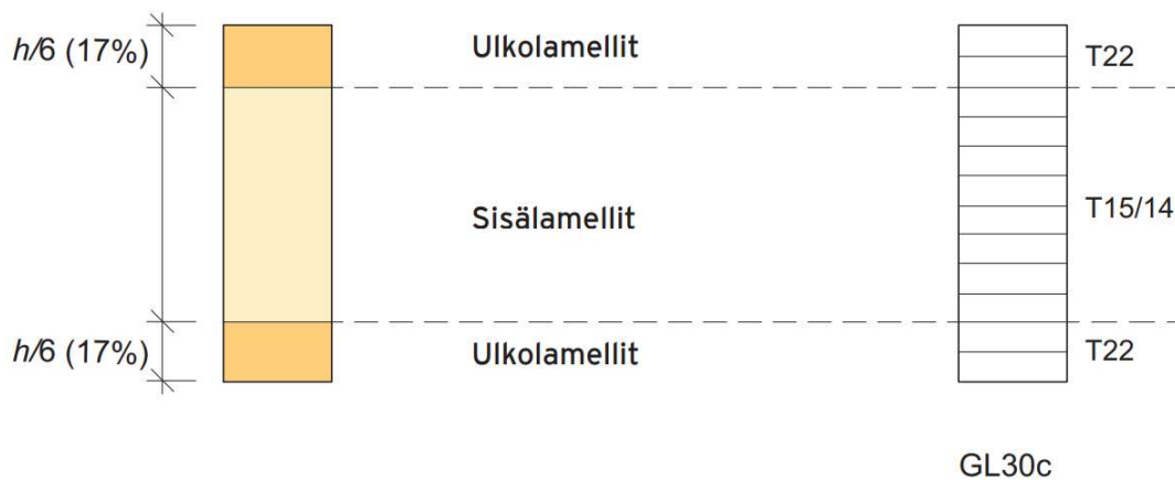
Kuva 1. GL30c poikkileikkaus (Liimapuukäsikirja Osa 1 2014, 23)
