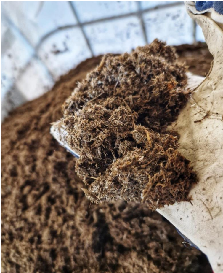
Kuva 3. Separoitu kuivajae on kuohkeaa ja kevyttä käsitellä
