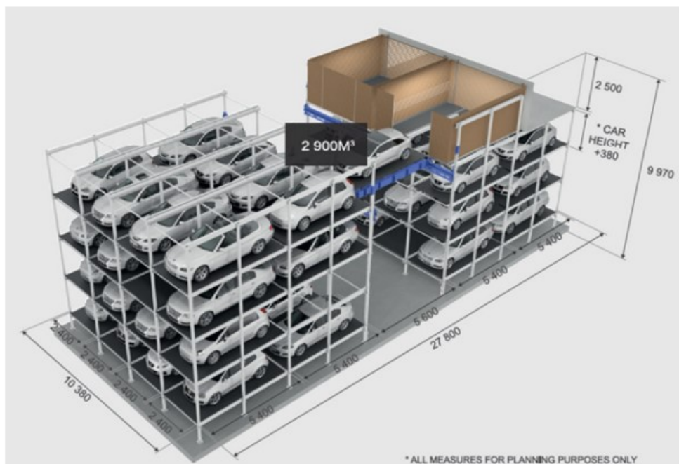
Figur 4. Exempel på mekaniskt parkeringshus. (RT 98-11237 Pysäköintlaitokset, s.15).
