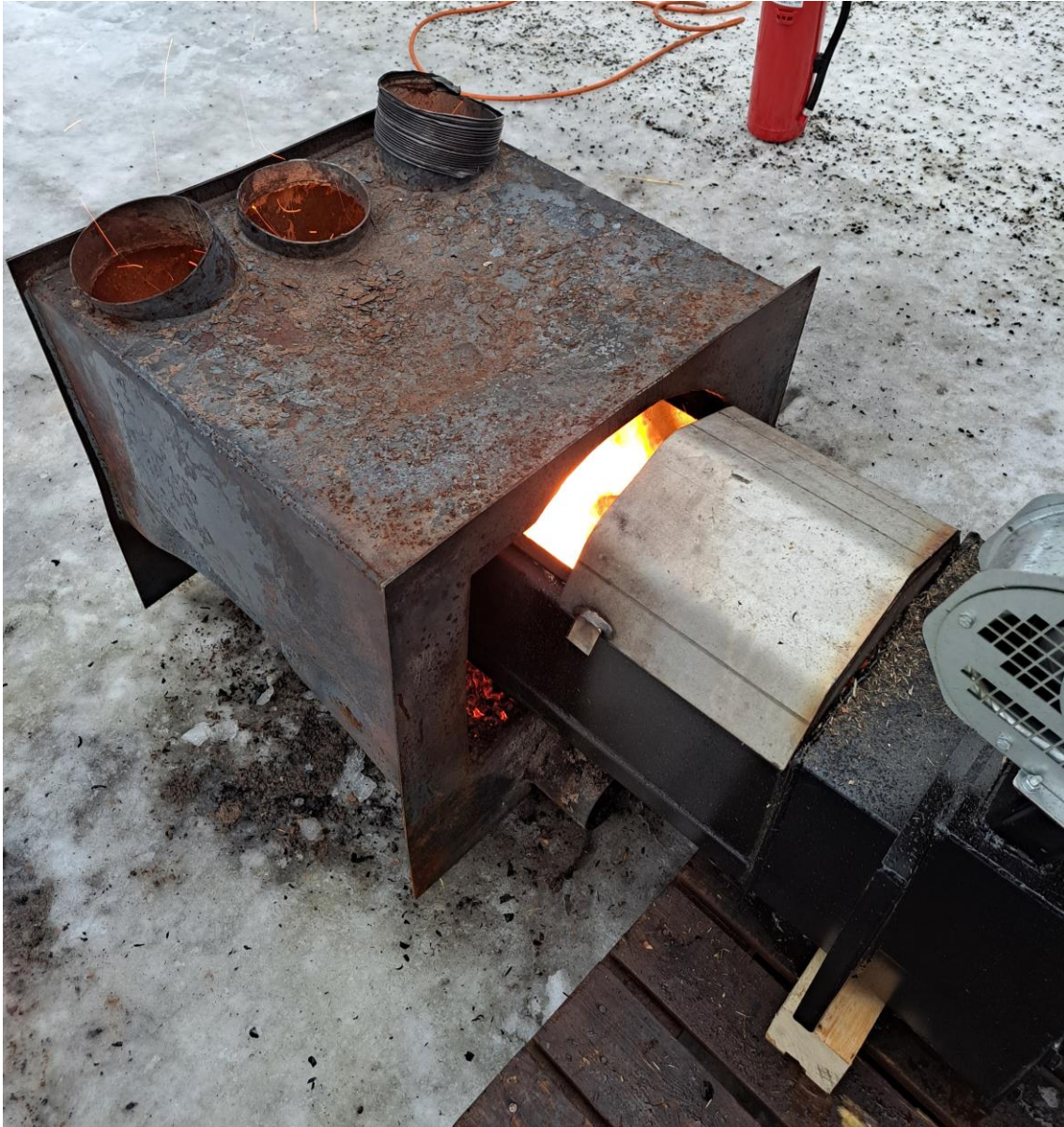
KUVA 8 Polttimen maksimi tehon testaus.
