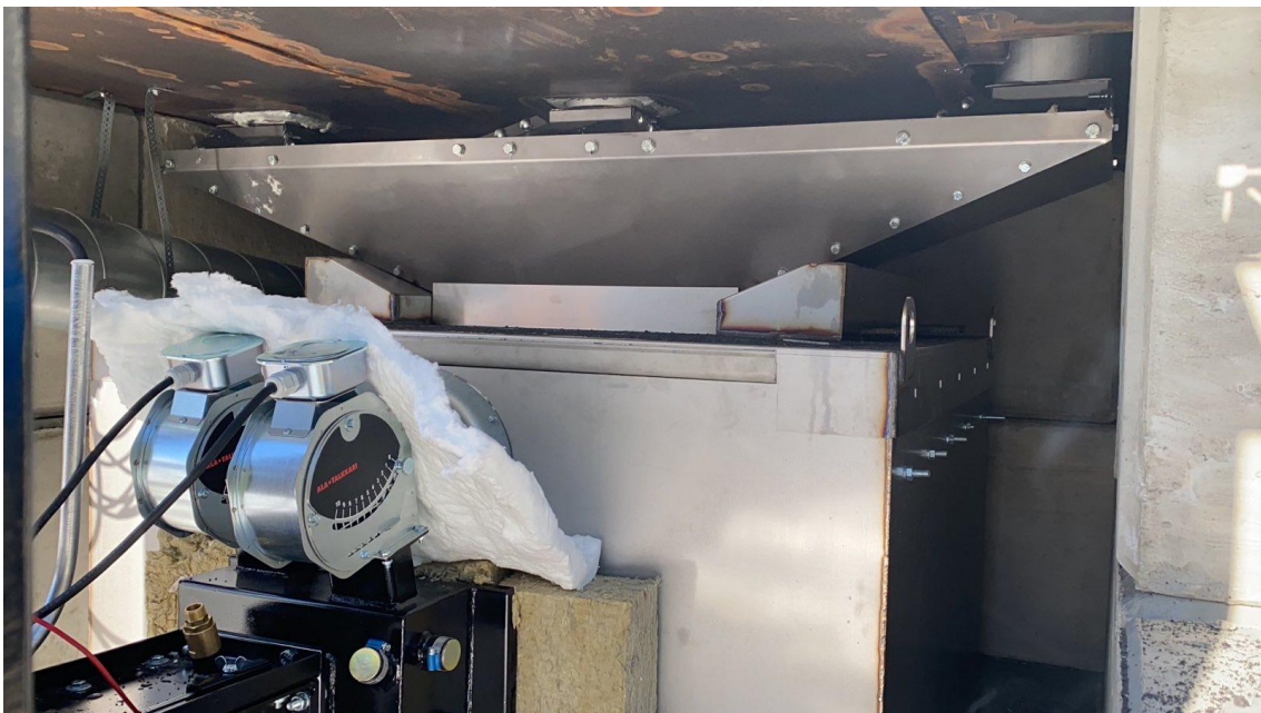
KUVA 18 Kanavan liittäminen reaktorin pohjaan.
