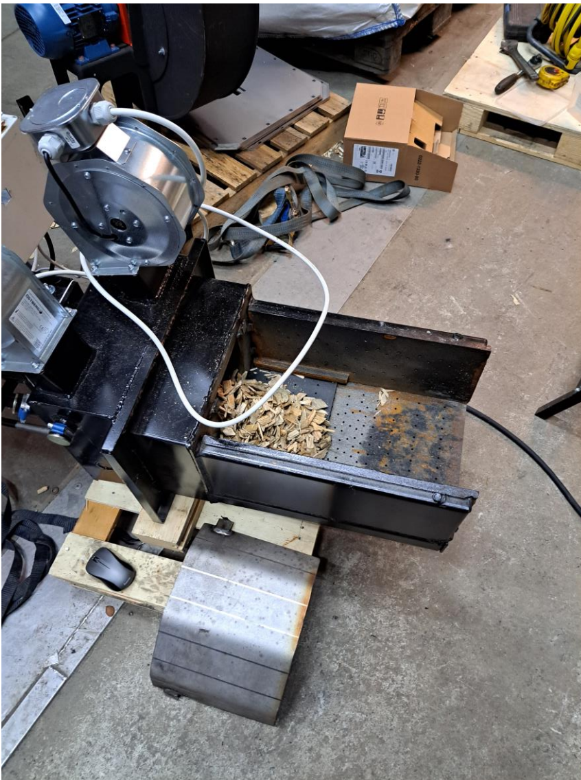
KUVA 3 Polttopää ja puhaltimet
