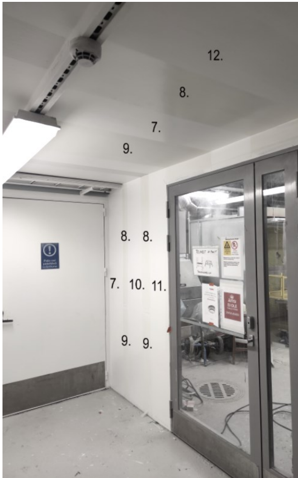
Kuva 5. Kuvassa tuotteet maalattuna koalueen oikealle puolelle. 7. Virtasen puolihihmeä seinämaali, 8. pellavaöljymaali, 9. kiinanpuuöljymaali, 10. Coloria puolihihmeä remonttimaali, 11. Uula puolihihmeä sisustusmaali sekä 12. Uula sisäpohjamaali (Kuva: Jaana Virta 2023).
