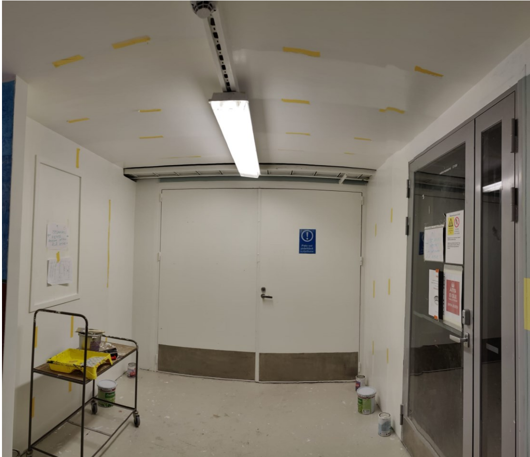
Kuva 2. Vertailtaviin maalien maalaustila Vantaan ammattiopisto Varian pintakäsittelyalan työsalissa. Kuvassa maalattuna nykyaikaiset maalit raitoina katoista lattiaan (Kuva: Jaana Virta 2023).
