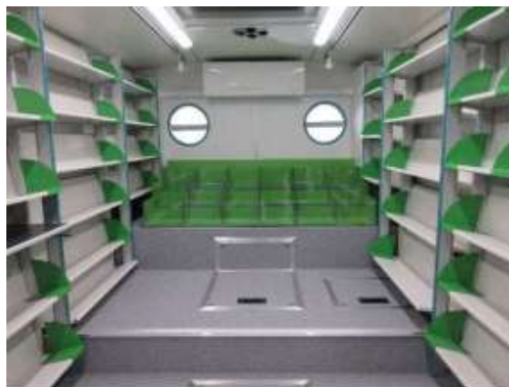
Kuva 9. Linja-autoalustan takana olevat pykälät (Kiitokori Oy 2023.)
