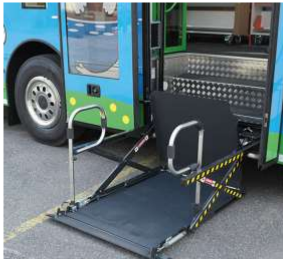
Kuva 12. Kirjastoauton perusedellytys on esteettömyys. Kuvassa sähköinen hissi liikuntarajoitteisille. (Kiitokori Oy 2023.)
