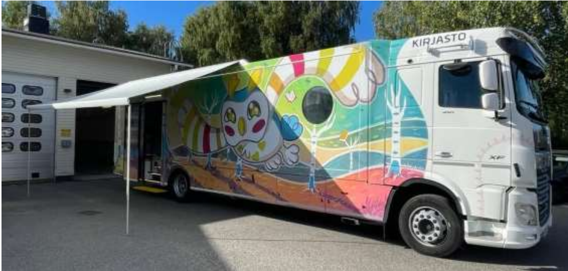
Kuva 17. Katolle asennettu kuuden metrin markiisi (Conlog 2023.)
