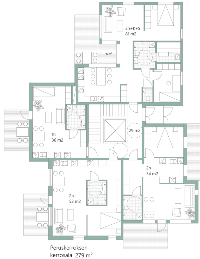
Kuva 27. Varhainen versio suunnitelmasta. Porrashuone on ti- lankäytöllisesti tehokas mutta pimeä, sillä se avautuu julkisi- vuun ainoastaan sisäänkäynnin kohdalta.
