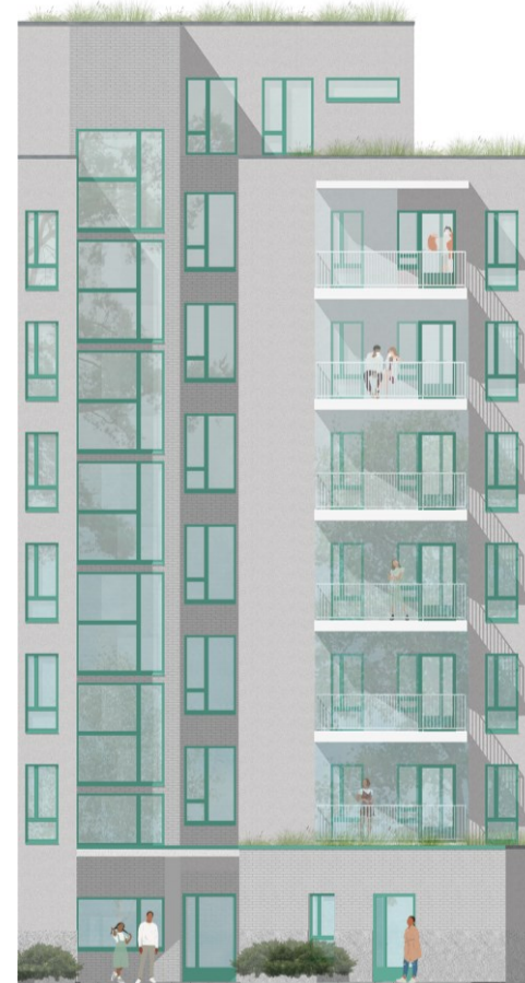
Kuva 32. Julkisivuote. Sisäänkäynnin sijainti korostuu julkisivussa syvennyksen ja asuntojen aukotuksesta poikkeavan aukotuksen avulla.
