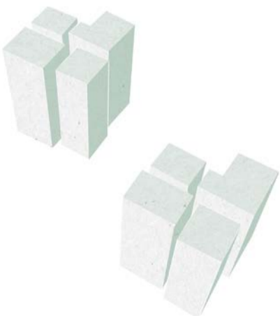
Massoittelu perustuu ajatukseen neljästä asuntotornista, jotka on sommiteltu porrashuoneen ympärille, tavoitteena asuntojen monipuolinen avautuminen eri ilmansuuntiin.
