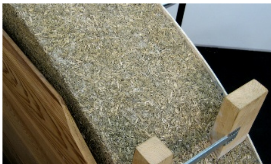
KUVA 29. Tradical® Hemcrete® voidaan valaa rakennuspaikalla puumuotteihin ja materiaali sopii myös hyvin käytettäväksi rakennusten entisöintien yhteydessä [91]
