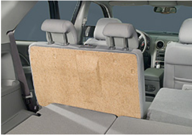
KUVA 34. FlexForm Technologies valmistaa autojen sisäverhouksia niinikuiduista ja kuidutetuista kestmuoveista valmistetusta materiaalista matalapaineisella puristusmuovauksella [94]
