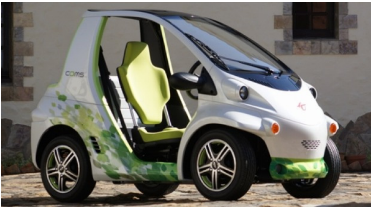
KUVA 35. Toyotan kehittämän COMS BP -sähköauton konepelti, katto ja pilarit on valmistettu kasvipohjaisista biomuoveista [95]
