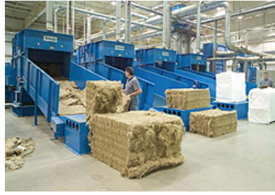
KUVA 34. FlexForm Technologies valmistaa autojen sisäverhouksia niinikuiduista ja kuidutetuista kestmuoveista valmistetusta materiaalista matalapaineisella puristusmuovauksella [94]
