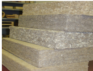
KUVA 32. Biokuitulujitteisia tiiliä ja äänen- ja lämmöneristyslevyjä [92]
