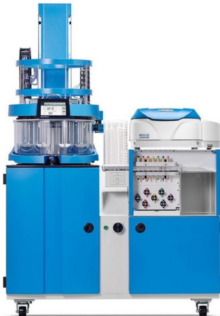
Kuva 8. Täysin automatisoitu liukenemisnopeutta määrittävä laite, jonka on valmistanut sveitsiläinen Sotax [20.]
