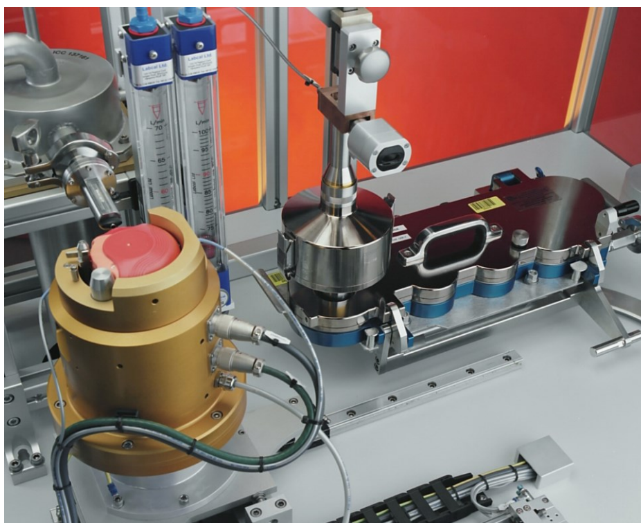
Kuva 5. FPD-analyysiä NGI-laitteistolla tekevä automatisointilaitte, jonka on valmistanut brittiläinen Astech [14].
