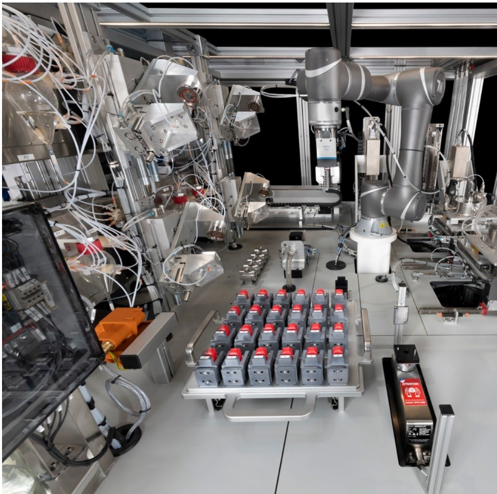
Kuva 6. Delivered Dose-näytteenottoa ja käsittelyä analyysivalmiiksi tekevä automatisointilaitte, jonka on valmistanut brittiläinen Astech [15].
