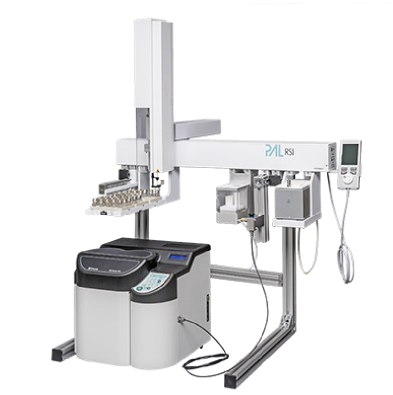
Kuva 11. Automatisoitu kokonaisnitrosamiinipitoisuutta määrittävä analysaattori, jonka on valmistanut brittiläinen Ellutia [29].
