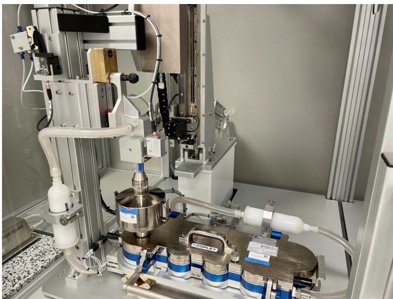
Kuva 1. Annosjakauma-analyysin ensimmäistä vaihetta eli annoksen ottamista ja inhalaatiojauheen jakautumista suorittava automatisointilaitte.
