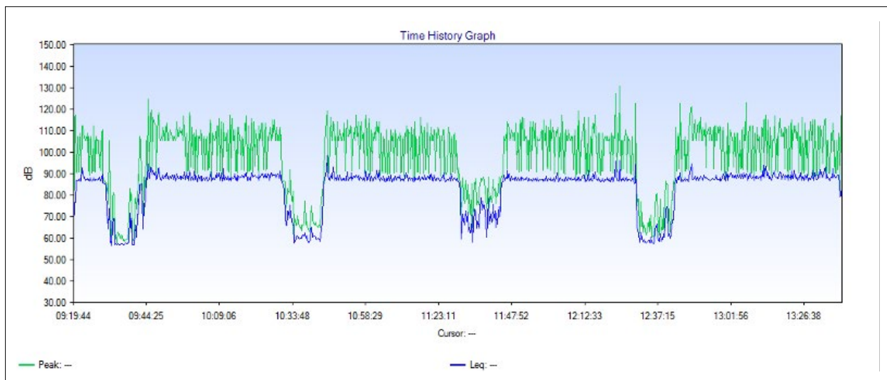
Kuva L5. Puhaltimo LD15 klo 9.19-13.39, LAeq = 87 dB ja LCpeak = 131 dB
