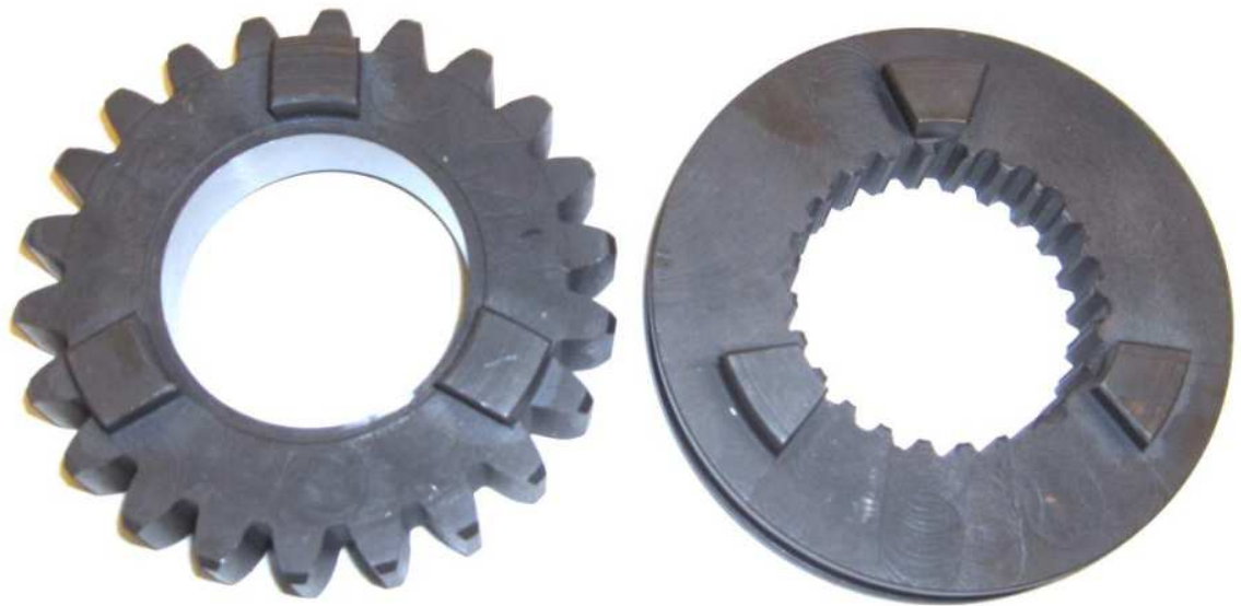
Kuva 10. Hammaspyörä vasemmalla ja kytkentärenkas oikealla.
