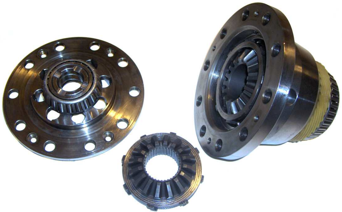
Kuva 3. Tasauspyörästön kitkalukko purettuna.
