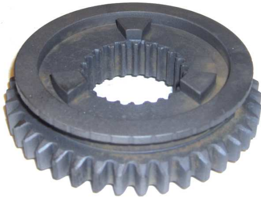
Kuva 9. Peruutusvaihteen hammaspyörä, jossa kytkentärenkaat.
