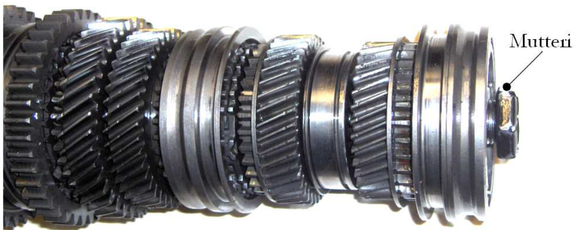
Kuva 11. Alkuperäisen akselin kokoaminen mutterin avulla.
