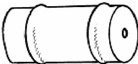
Kuva 13 Rullissa voi esiintyä pantoja [5, s. 98.]
