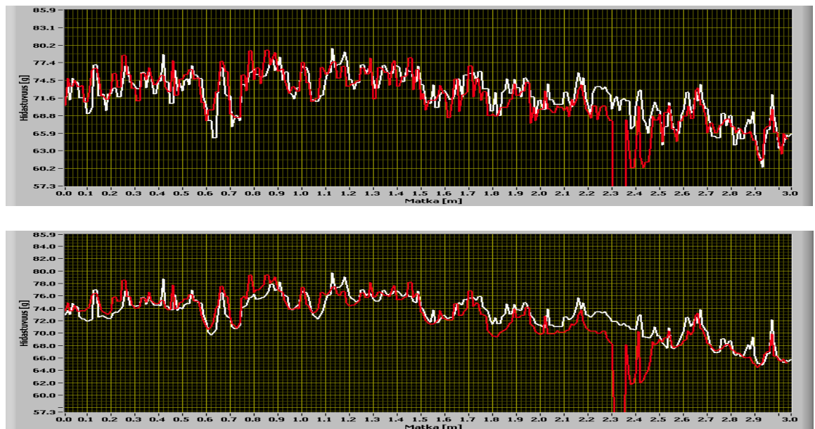
Kuva 34 Suodatuksella voidaan mittauksesta poistaa häiritsevä kohina
