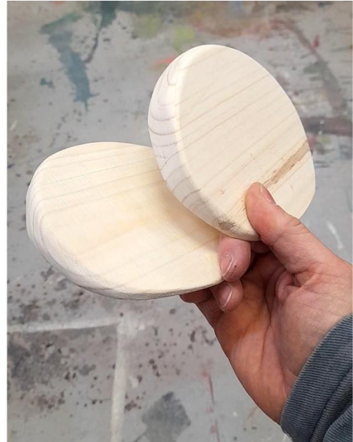
Kuva 7: Kaltevat tasot suoristamaan vääntyneiden veistosten asentoa.
