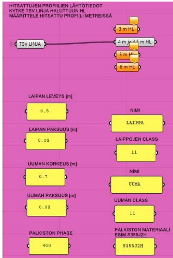
Kuva 14 Hitsattujen profiilien lähtötiedot. Lähtötietoihin syötetään laippojen ja uuman profiilit sekä Teklaan vietävät materiaalitiedot
