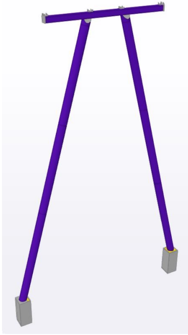
Kuva 19. Tyypillinen A-jalkarakenne, jonka yläpään hitsaamalla kiinnitetty vaakapalkki
