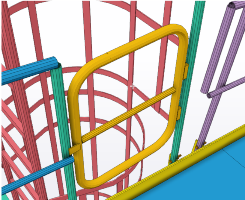
Kuva 36. Mallinnettu jousikuormitettu itsestään sulkeutuva portti
