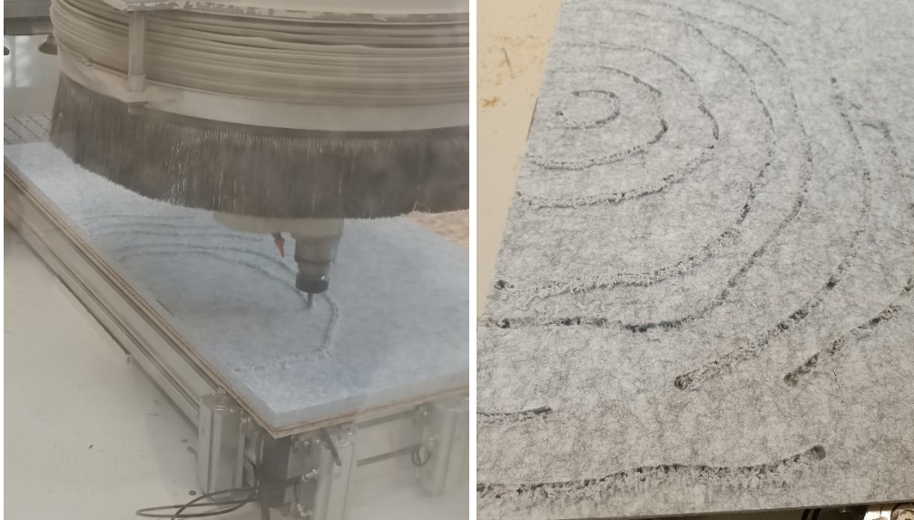
Kuva 7. Ensimmäisen kuviodun prototyypin jyrsiä CNC-koneella
