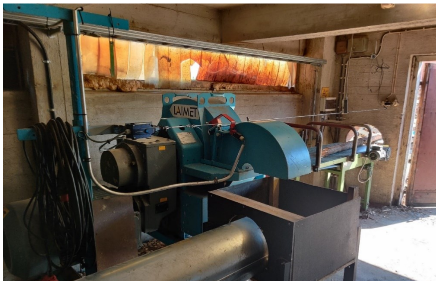
Kuva 20. Hakkuri ja kotelo, josta puhallin imee hakkeen (Rahkjärvi, 2020a).
