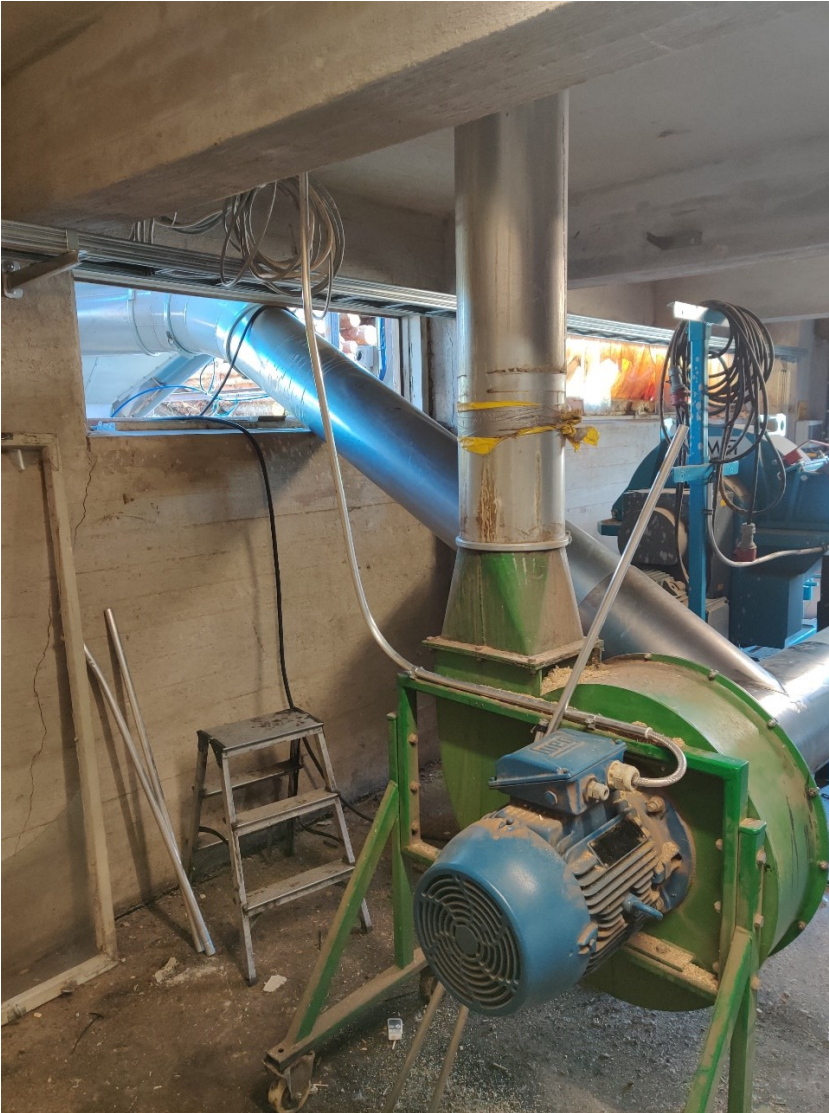
Kuva 14. Hakkurin puhallin (Rahkjärvi, 2020f).
