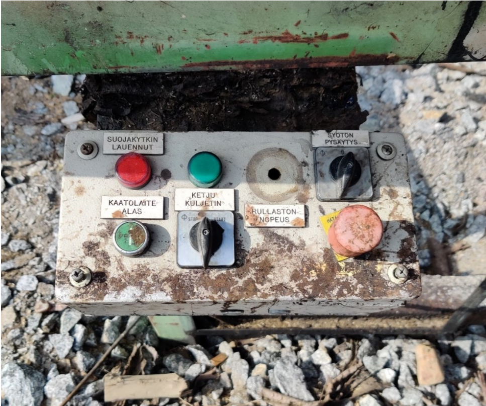
Kuva 10. Kuljettimien vanha käyttöpaneeli (Rahkjärvi, 2020h).
